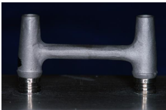
Figura 8. Infraestrutura após soldagem convencional posicionada no modelo mestre
