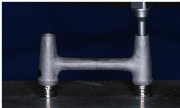
Figura 12. Infraestrutura metálica posicionada recebendo torque de 10Ncm em um dos pilares
