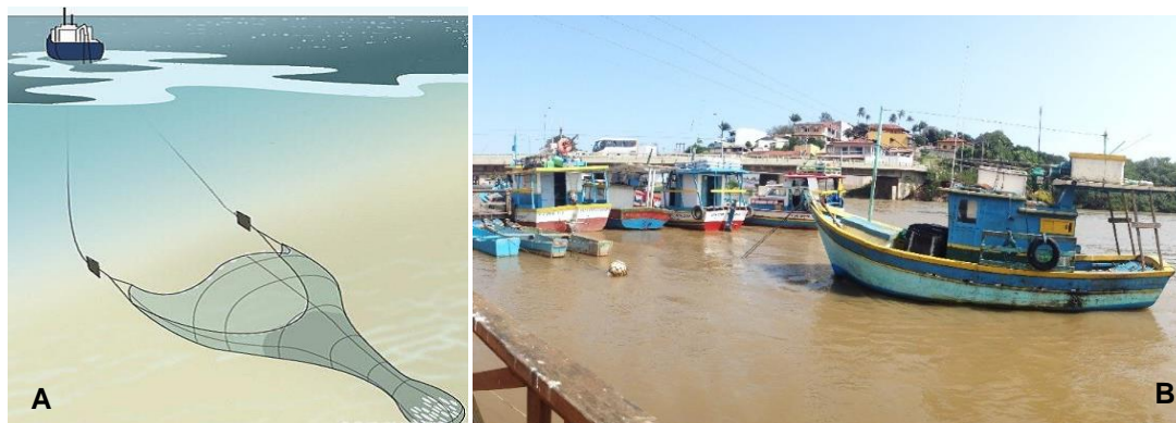
Figura 2 – (A) Esquema da embarcação modelo saveiro médio equipado com uma rede de arrasto do tipo “otter trawl”. Disponível em: < http://explow.com/trawling >. (B) Foto de embarcação do tipo saveiro utilizada na pesca artesanal de arrasto do litoral sul do Espírito Santo (Arquivo pessoal).
