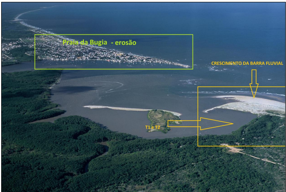
Figura 48 – Fotografia oblíqua aérea da foz do rio São Mateus, Conceição da Barra, em 2001, mostrando o início do crescimento da barra fluvial à margem direita, bem como o banco sedimentos remanescente da antiga barra fluvial da margem esquerda do rio. Foto cedida por: André Alves.
