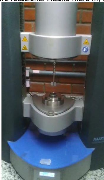
Figura 12 - Reômetro rotacional Haake Mars III, com geometria vane
