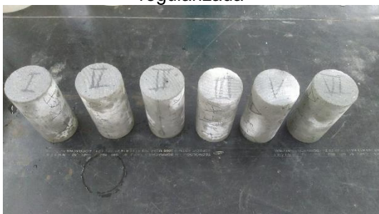
Figura 46 - A-REF com superfície regularizada
