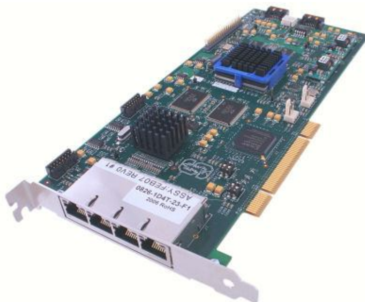
Figura A1. 2 - Placa NetFPGA de 1Gbps.
