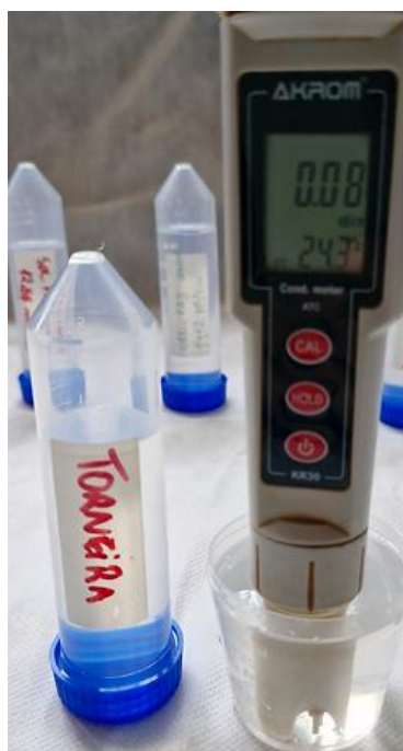
Figura 43 – Leitura da condutividade elétrica da água com condutivímetro portátil.
