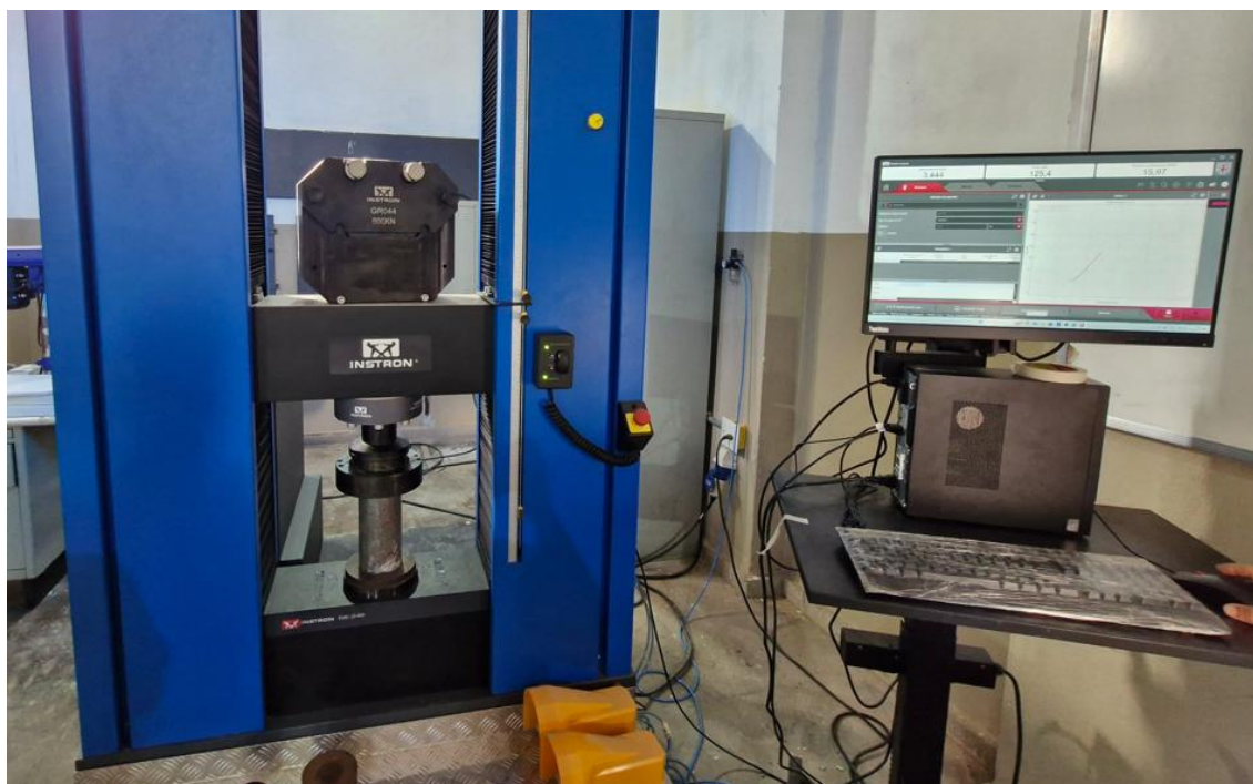
Figura 45 – Ensaio de resistência à compressão em máquina universal de ensaios.
