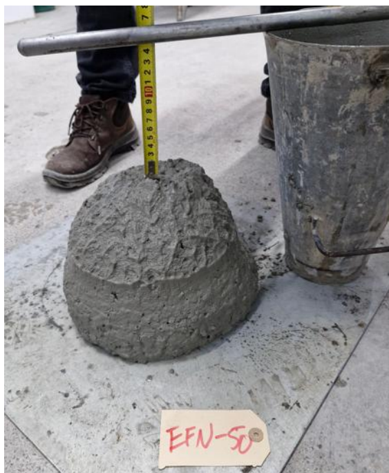
Figura 44 – Leitura do abatimento de tronco de cone para o traço EFN50.
