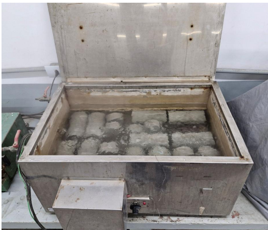
Figura 46 – Tanque de ebulição com corpos de prova submersos durante o ensaio de imersão em água.
