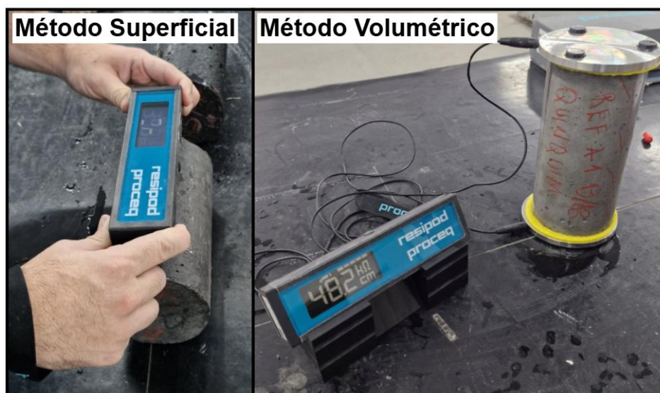
Figura 57 – Equipamento Resipod em uso.
