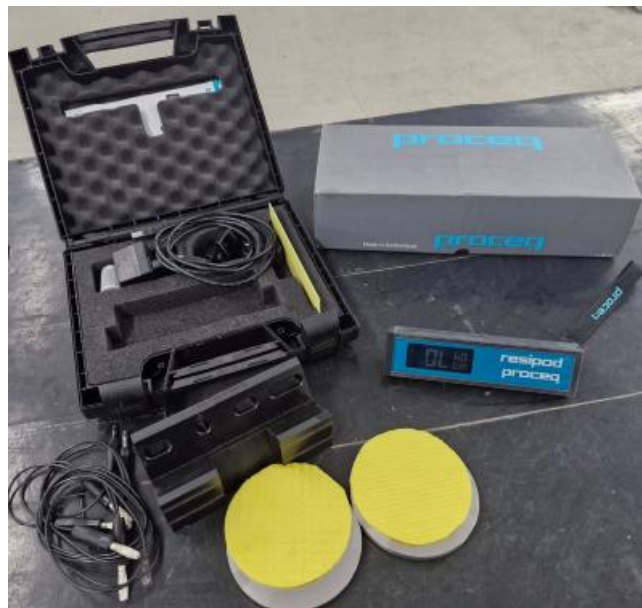
Figura 56 – Equipamento de ensaio de Resistividade - Proceq Resipod.
