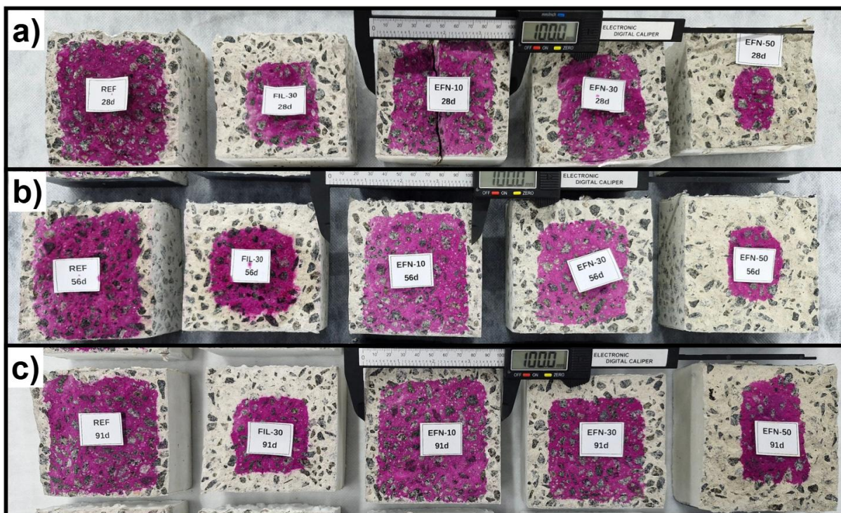
Figura 55 – Corpos de prova carbonatados: a) 28dias; b) 56dias; c) 91dias.
