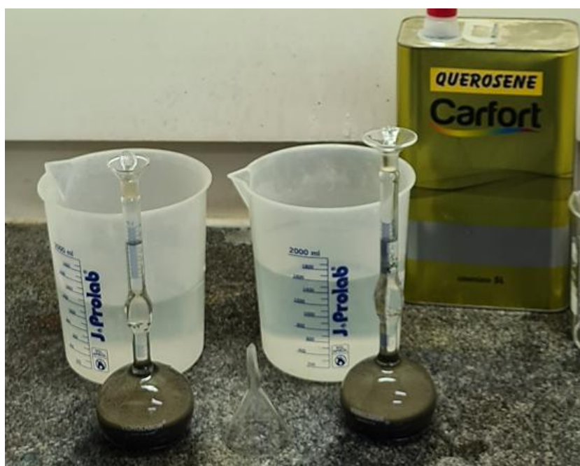
Figura 33 – Determinação da massa específica - leitura do frasco volumétrico de Le Chatelier.
