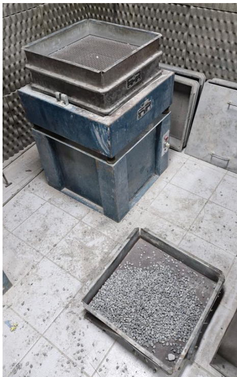
Figura 40 – Peneiramento da brita e separação entre malhas #9,5 e #4,75mm.
