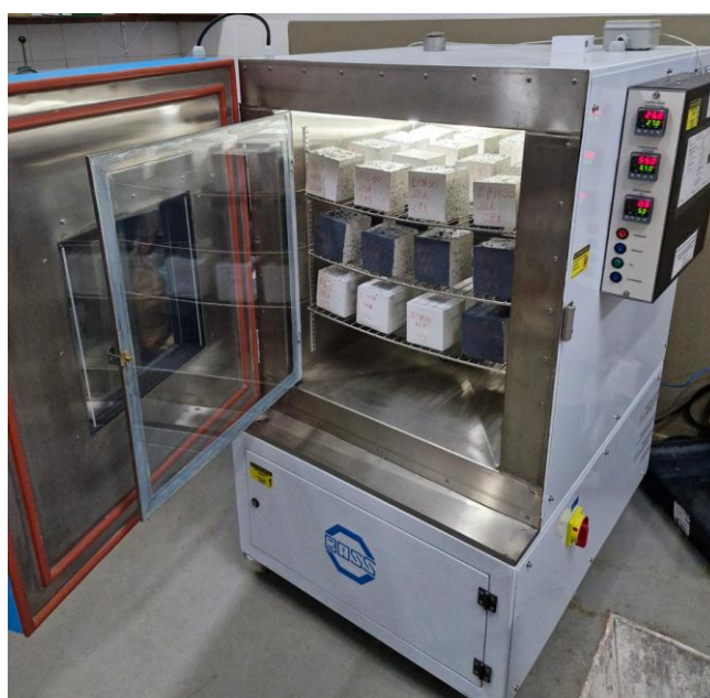
Figura 54 - Câmara climática de carbonatação utilizada com CPs cúbicos no interior.
