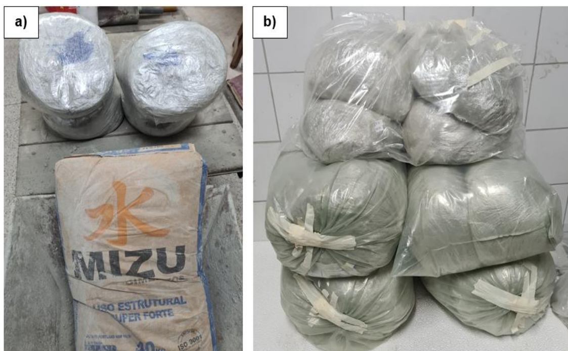
Figura 28 – Armazenamento do Cimento: a) Fracionamento com indicador de umidade; b) Sacos fracionados em Câmara seca.
