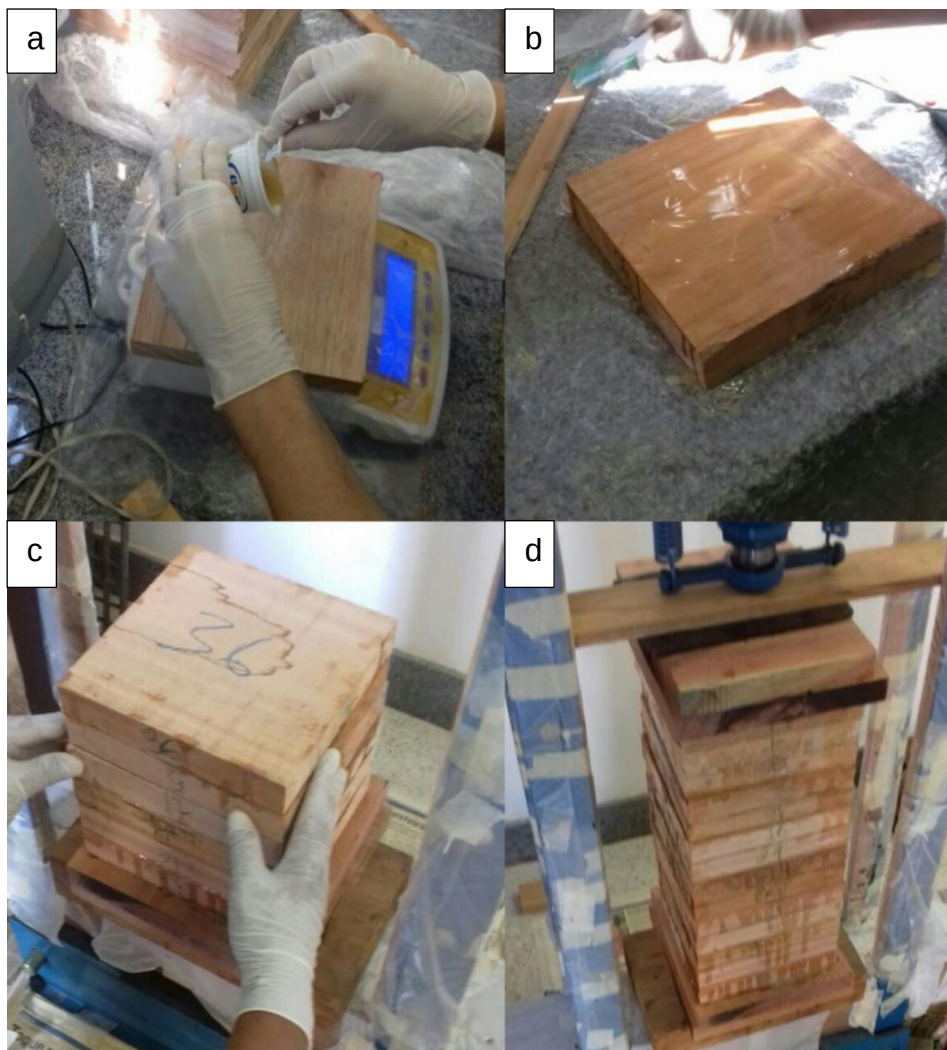
Figura 1. Etapas de preparação dos blocos de madeira laminada colada. a) Aplicação do adesivo; b) Espalhamento do adesivo; c) Montagem dos elementos de madeira laminada colada - MLC; d) Aplicação de pressão constante.
