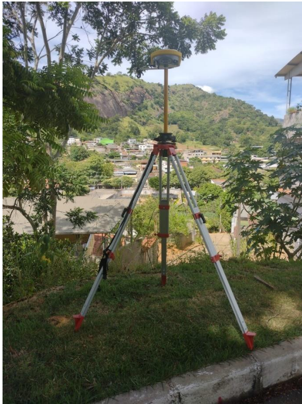
Figura 4. Global Navigation Satellite System (GNSS) utilizado como base, alocado para estabilização.
