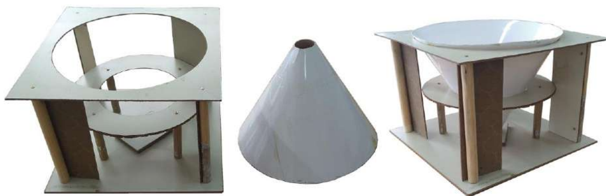
Fig107: Magnago. Fôrma para fundir gesso, 2024 (29 x 40 x 40 cm) chapa de fibra de madeira, madeira e PVC em folha. Fonte: acervo do autor.
