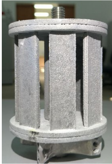
Figura 58 – Incrustação superficial na gaiola e nos cupons.
