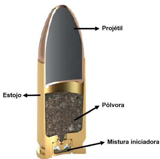
Figura 3: Representação de cartucho de AF e elementos essenciais – Adaptada.
