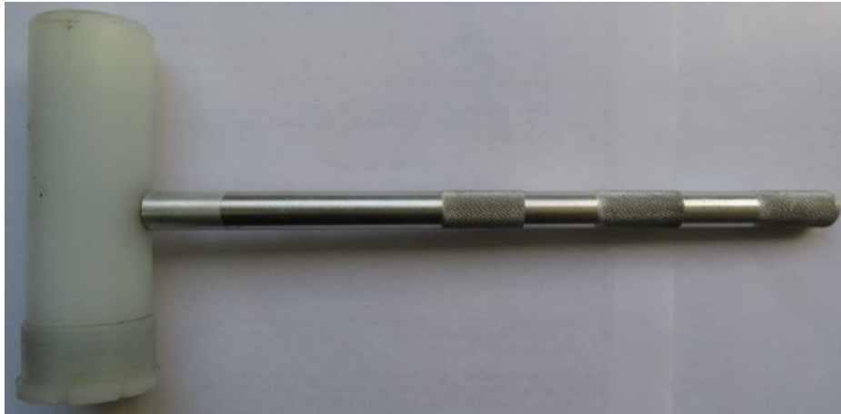
Figura 17: Martelo de inércia utilizado para descarga de munição.
