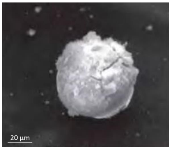
Figura 6: Microfotografia de GSR munição convencional.
