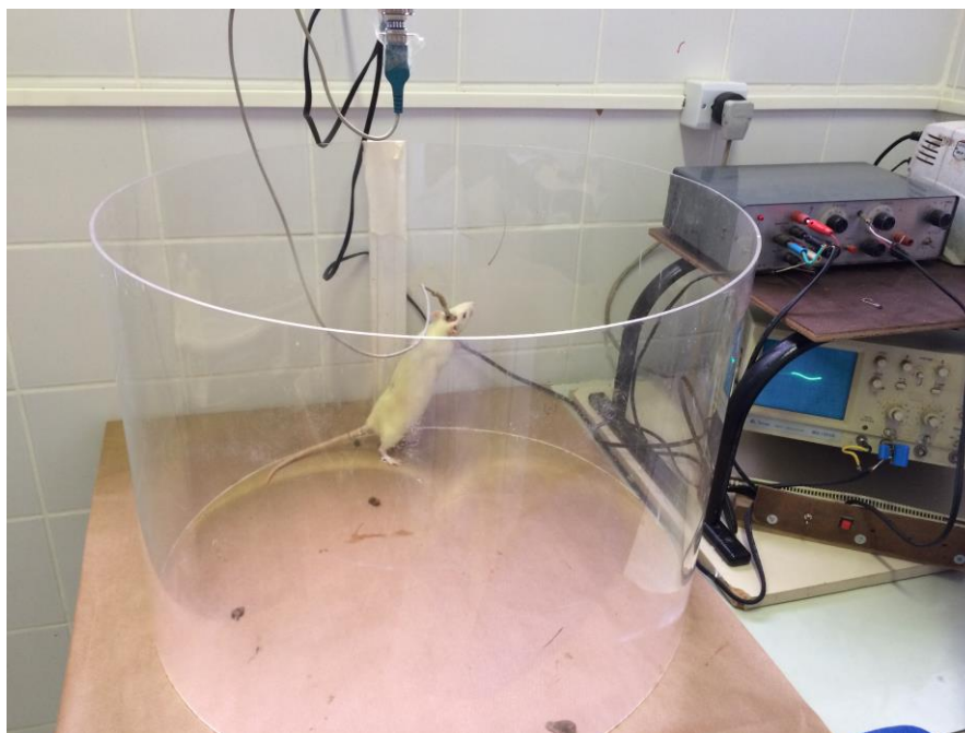
Figura 7: Montagem da estimulação elétrica intracraniana, onde pode-se observar o animal na arena de acrílico com eletrodo implantado conectado ao estimulador de pulso senoidal que é monitorado por um osciloscópio analógico. Fonte: Arquivo pessoal.
