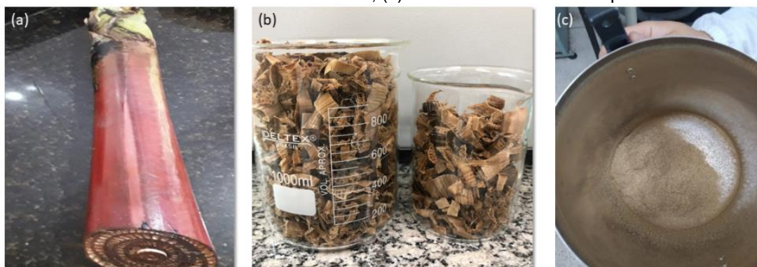
Figura 28. Etapas de preparação do pseudocaule da bananeira. (a) Pseudocaule in natura ; (b) Pseudocaule cortado e seco; (c) Pseudocaule moído em pó.
