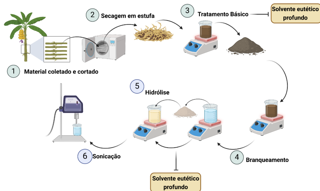
Figura 19. Fibra bruta do pseudocaule da banana após o processo de coleta, secagem, moagem, branqueamento, hidrólise, diálise e sonicação.
