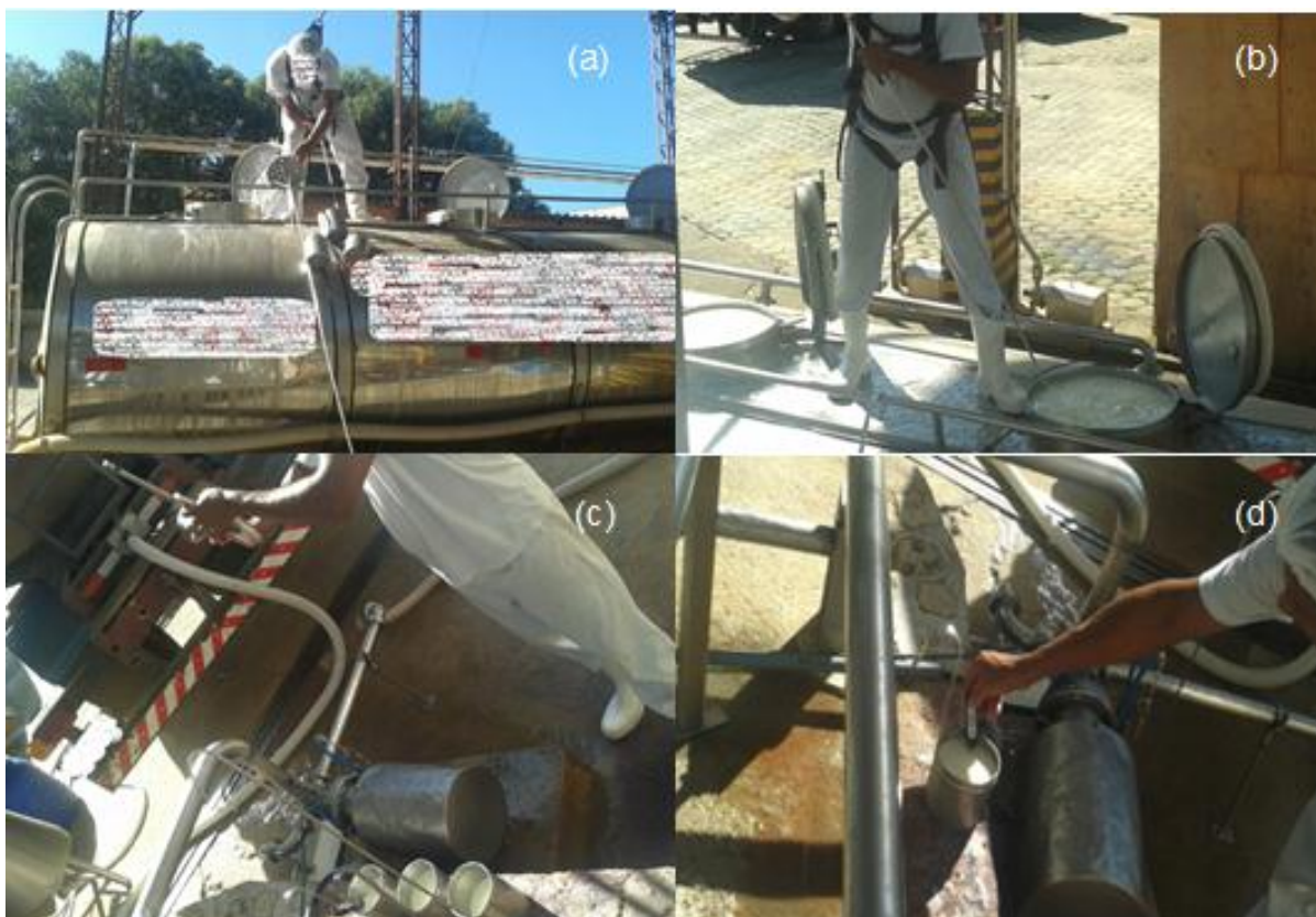
Figura 18. Homogeneização do leite para coleta de amostras (a, b); teste do alizarol realizado nas amostras de leite cru (c); aferição da temperatura de chegada do leite (d)
