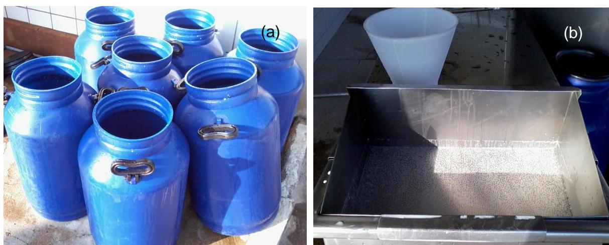
Figura 23. Latões utilizados no transporte do leite cru (a); o tanque de estocagem do leite (b)
