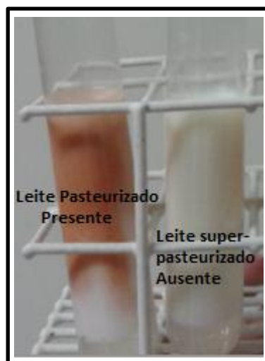
Figura 8. Teste da presença das enzimas peroxidase em leite cru e pasteurizado
