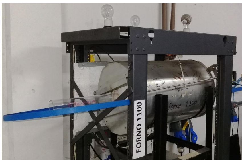
Figura 13. Forno tubular de quartzo utilizado no preparo das amostras CA_ \text{CaCO}_3 .
