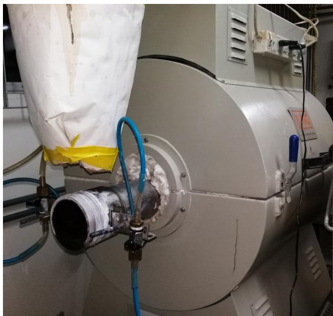
Figura 14. Forno tubular onde todos os catalisadores passaram por diferentes tratamentos térmicos.
