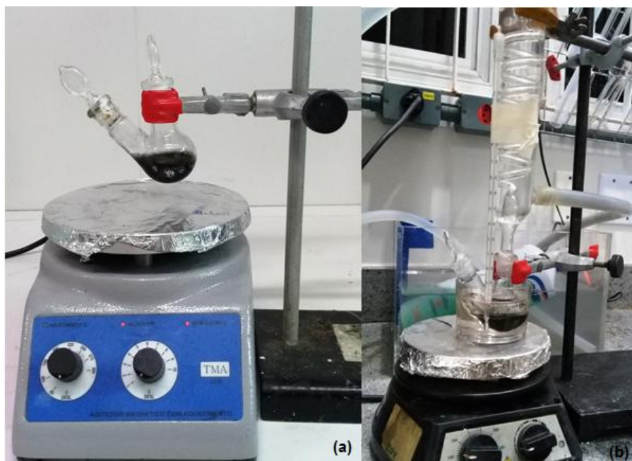
Figura 15. Ilustração típica do aparato laboratorial para a síntese de biodiesel apresentada neste trabalho. (a) Agitação magnética em temperatura ambiente da mistura metanol + catalisador. (b) Reação de transesterificação entre o óleo de soja e metanol com uso do catalisador sob refluxo.
