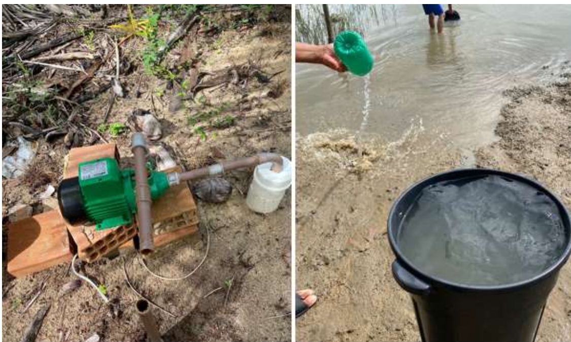
Figura 12 - Bomba centrífuga quebrada e captura da água do rio
