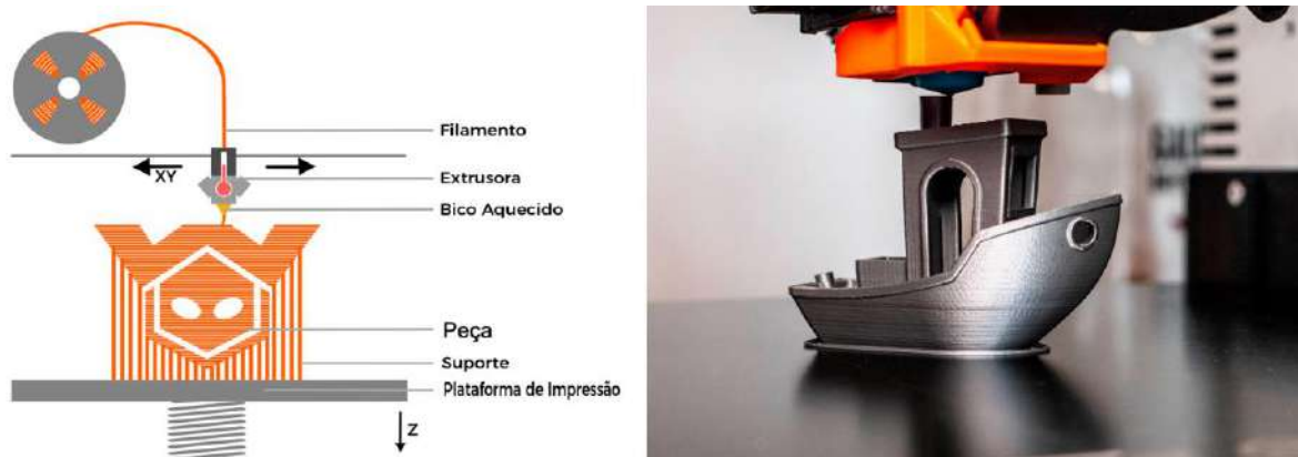
Figura 57: Processo de impressão 3D em FDM e modelo impresso.
