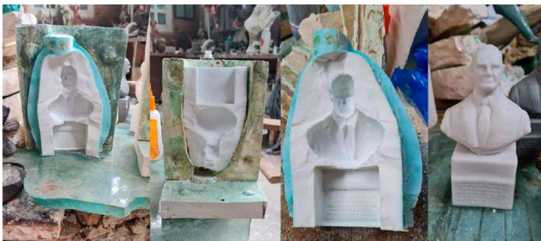
Figura 70: Protótipo de molde em silicone e berço em gesso; teste de sua usabilidade em visita ao ateliê do artista.
