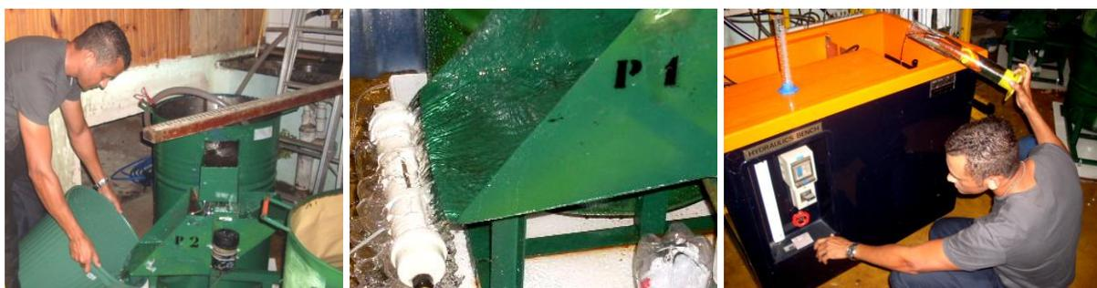
Figura 19 – Calibração dos medidores de fluxo
