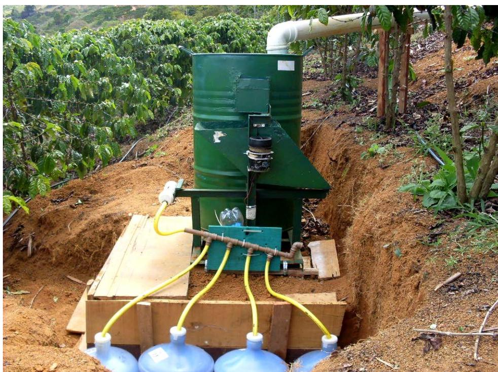
Figura 25 – Medidor de fluxo P2.
