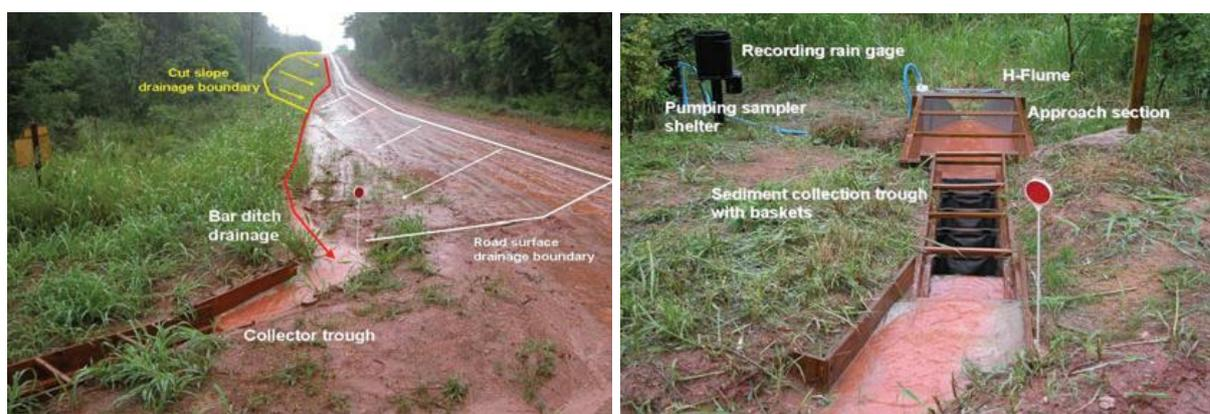
Figura 10 – Amostragem com calhas e amostradores automáticos.
