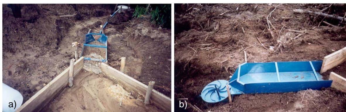
Figura 11 – Amostrador de enxurrada tipo Coshocton.
