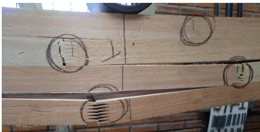
Figura A12 - Forma de ruptura da Viga 12 de Eucalipto
