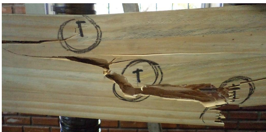
Figura B9 – Forma de ruptura da Viga 09 de Pinus
