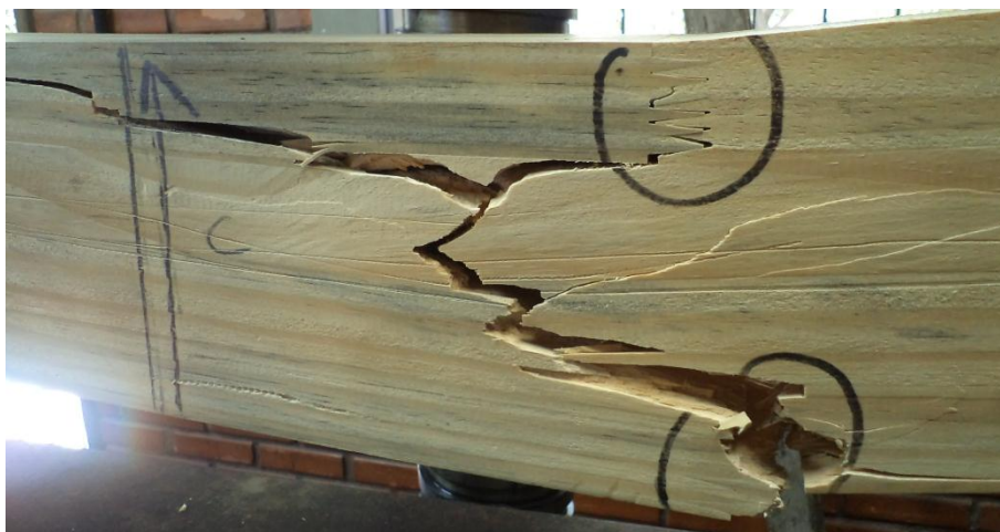
Figura B5 – Forma de ruptura da Viga 05 de Pinus
