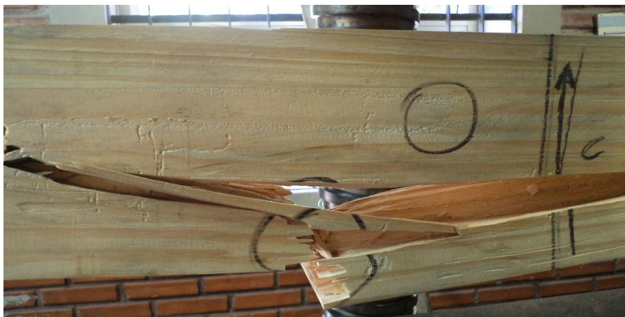
Figura B4 – Forma de ruptura da Viga 04 de Pinus
