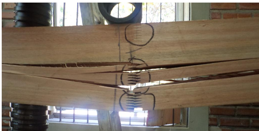
Figura A4 - Forma de ruptura da Viga 04 de Eucalipto
