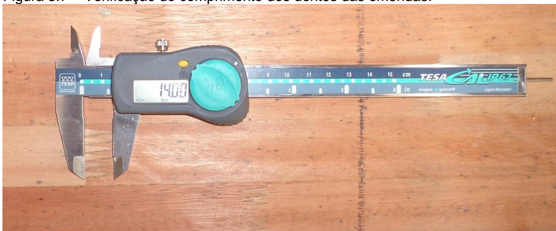
Figura 3.7 – Verificação do comprimento dos dentes das emendas.
