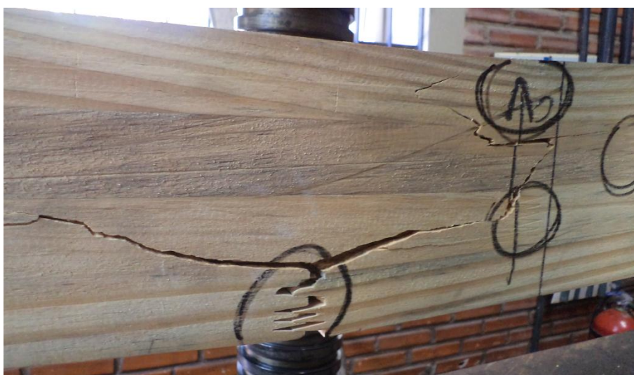
Figura B6 – Forma de ruptura da Viga 06 de Pinus
