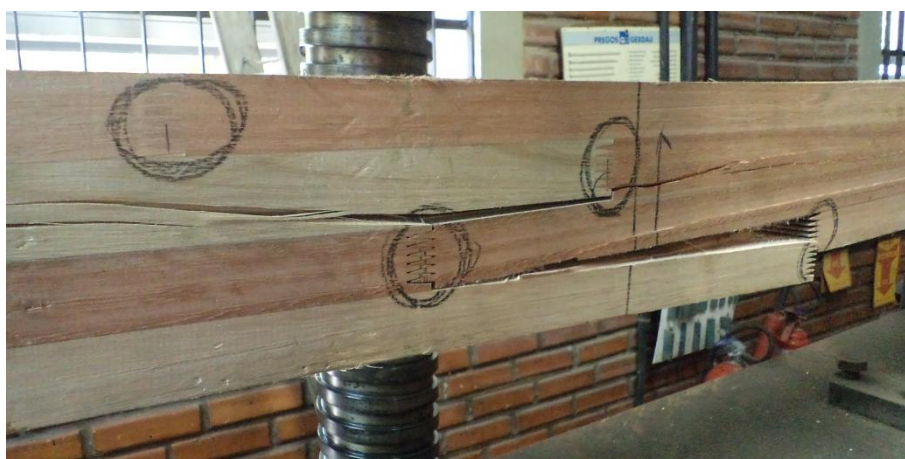
Figura A8 - Forma de ruptura da Viga 08 de Eucalipto
