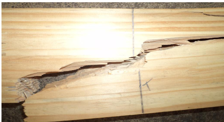
Figura B1 – Forma de ruptura da Viga 01 de Pinus
