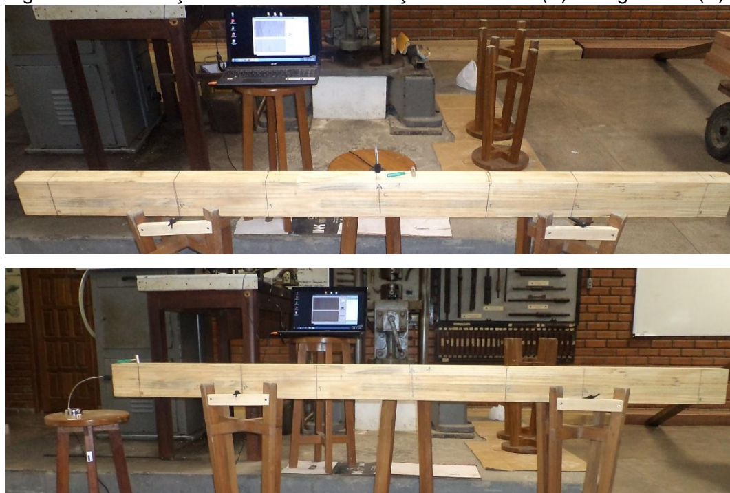
Figura 7.7 – Execução dos ensaios de vibração transversal (A) e longitudinal (B).
