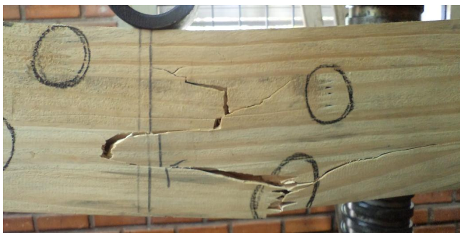
Figura B11 – Forma de ruptura da Viga 11 de Pinus
