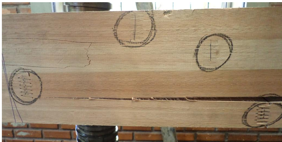
Figura A7 - Forma de ruptura da Viga 07 de Eucalipto
