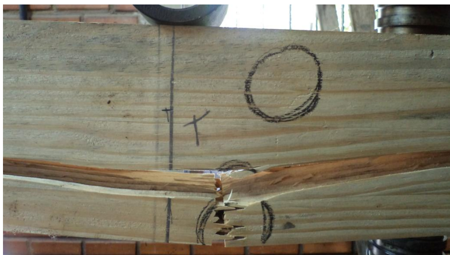
Figura B10 – Forma de ruptura da Viga 10 de Pinus
