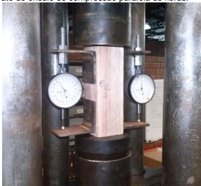
Figura 5.6 – Aparato de ensaio de compressão paralela às fibras.
