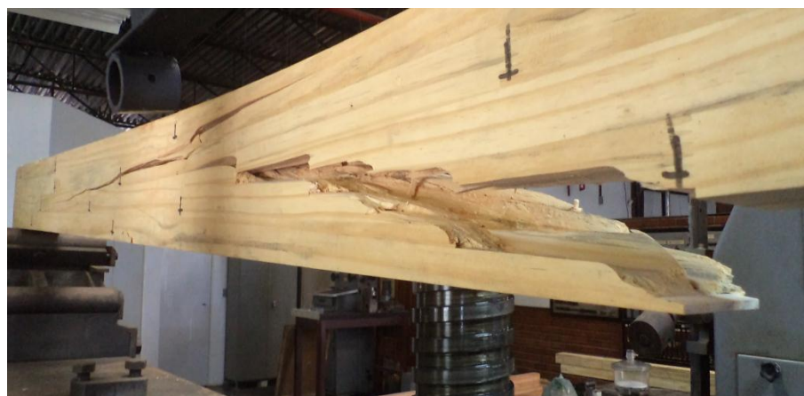
Figura B3 – Forma de ruptura da Viga 03 de Pinus
