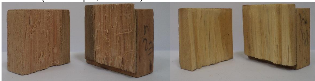
Figura 4.15 – Rupturas anômalas em corpos de prova de cisalhamento na linha de cola saturada (E= Eucalipto; P = Pinus).
