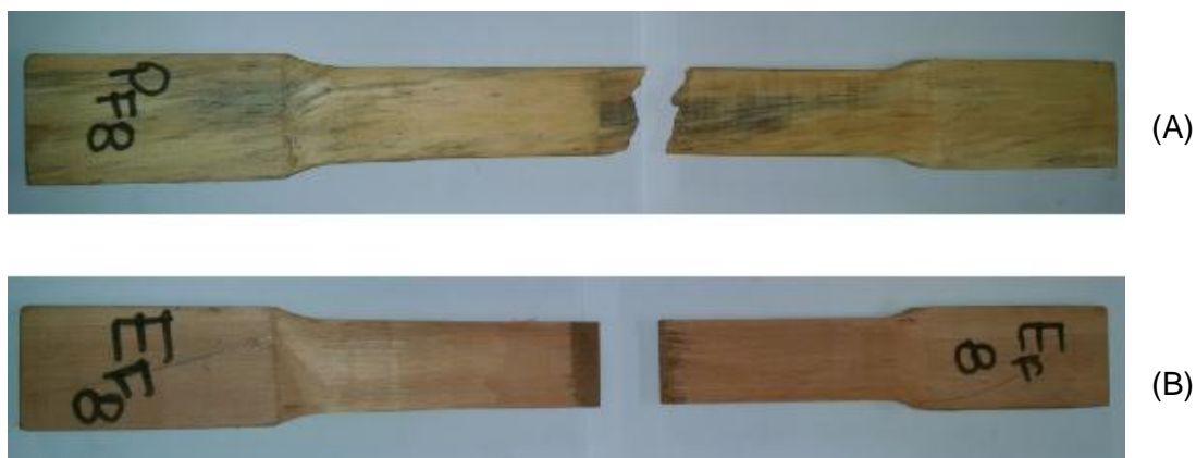
Figura 6.4 – Rompimento dos corpos de prova sujeitos a tração na emenda colada para (A) Pinus e (B) Eucalipto.
