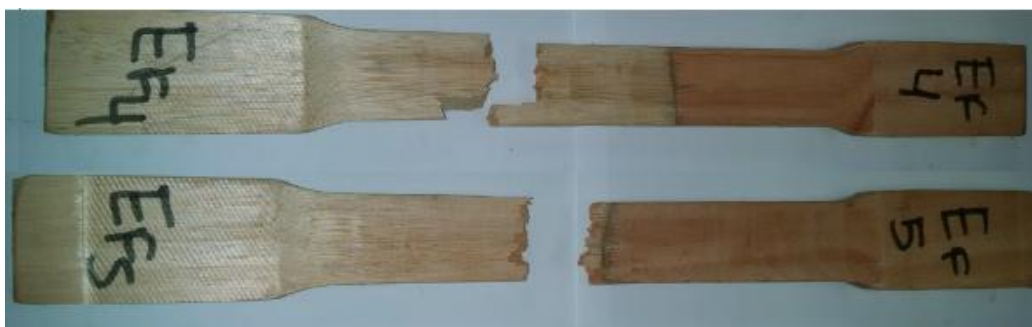
Figura 6.5 – Corpos de prova de eucalipto com variação de lenho.
