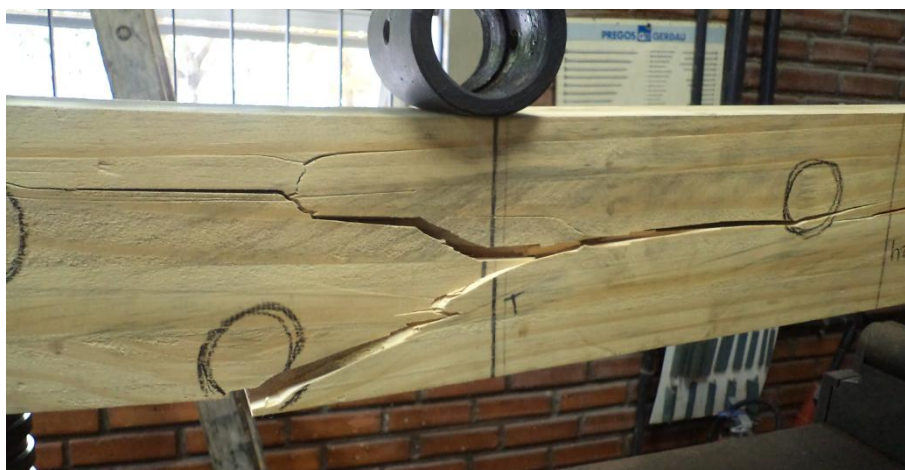
Figura B8 – Forma de ruptura da Viga 08 de Pinus
