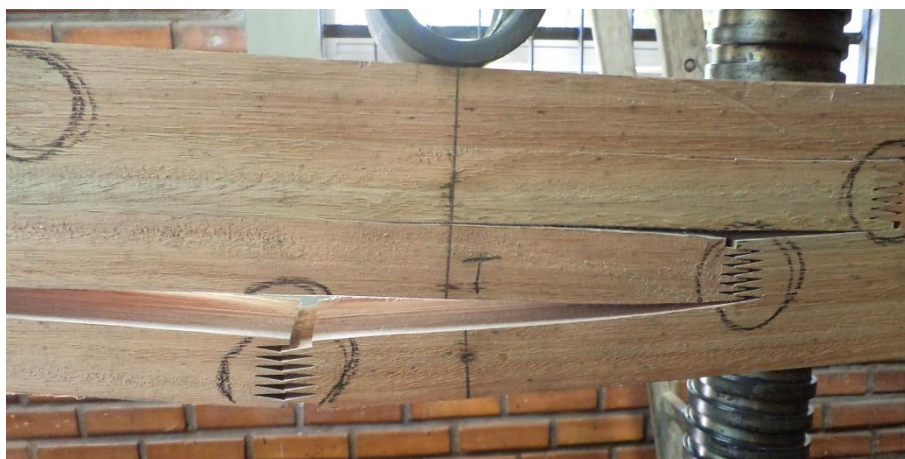
Figura A10 - Forma de ruptura da Viga 10 de Eucalipto
