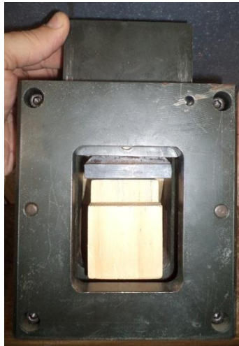
Figura 4.7 - Aparato de cisalhamento.
