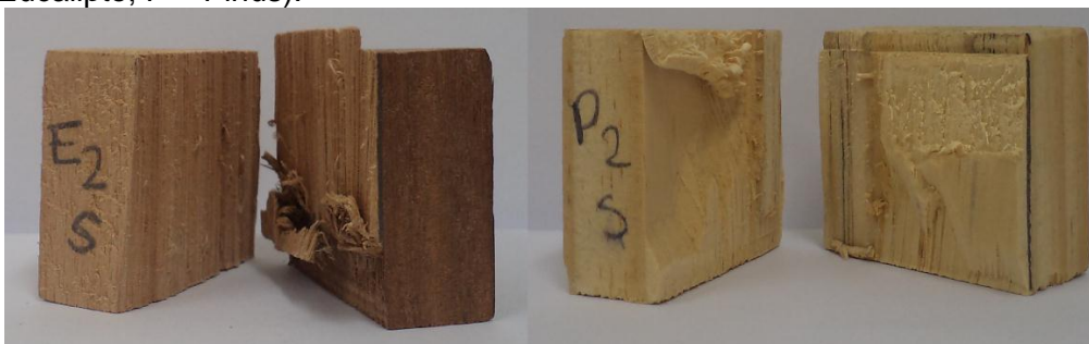
Figura 4.13 – Ruptura em corpos de prova de cisalhamento na linha de cola seca (E= Eucalipto; P = Pinus).
