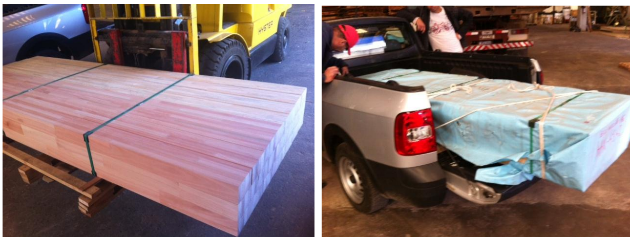
Figura 3.2 – Estocagem e transporte das vigas de MLC.
