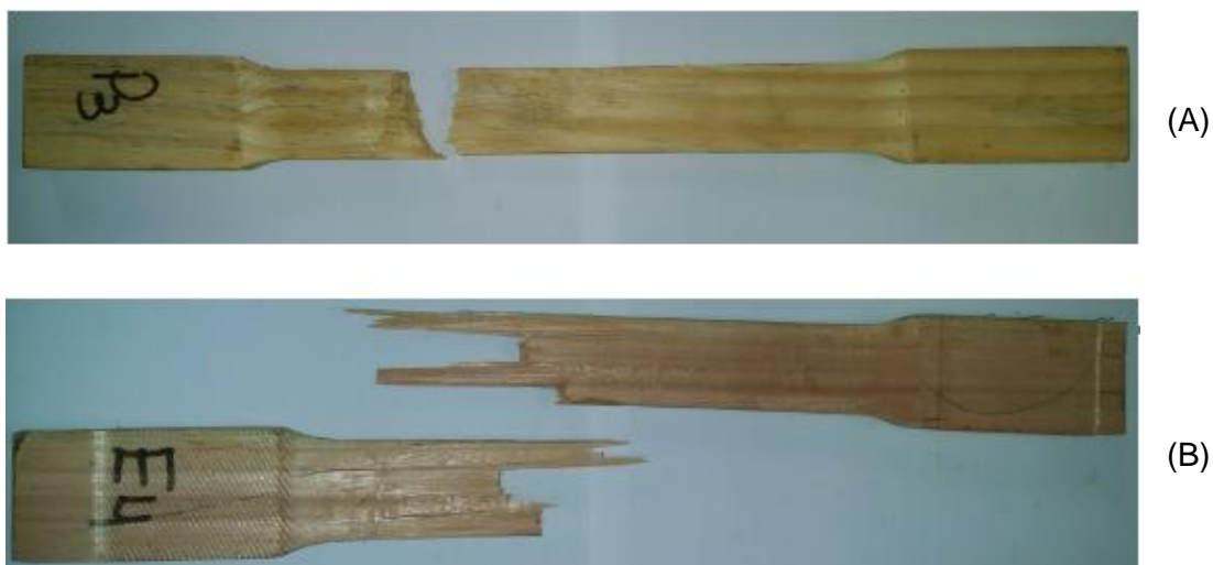
Figura 6.6 – Rompimento dos corpos de prova sujeitos a tração na madeira (A) Pinus e (B) Eucalipto.
