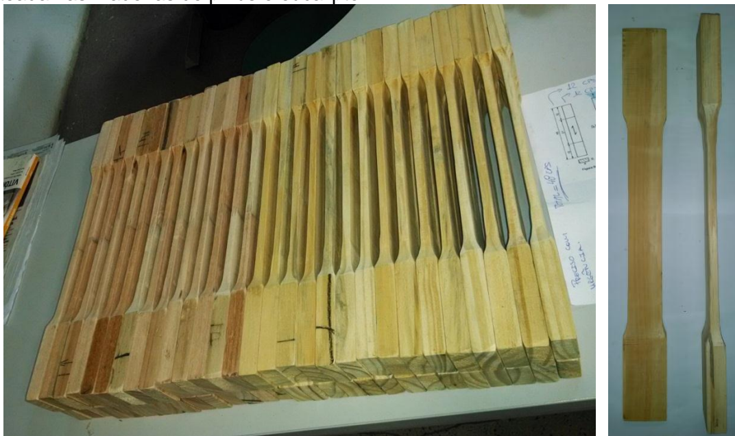
Figura 6.2 – Corpos de prova de tração paralela às fibras da madeira e da emenda denteada nas madeiras de pinus e eucalipto.
