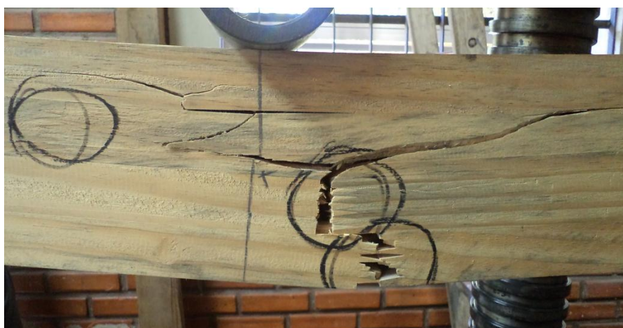
Figura B2 – Forma de ruptura da Viga 02 de Pinus
