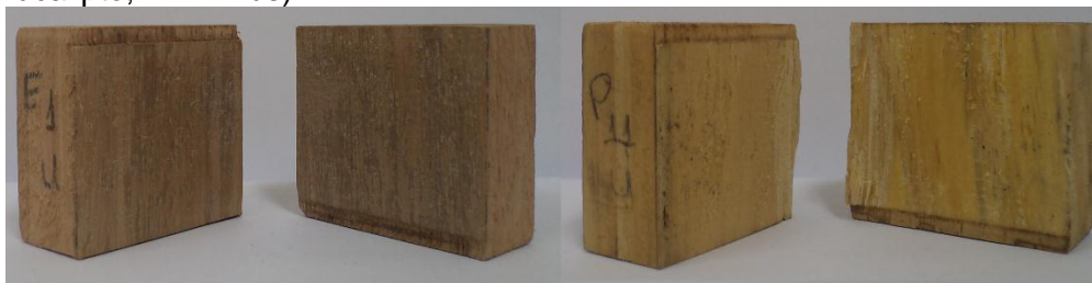
Figura 4.14 – Ruptura em corpos de prova de cisalhamento na linha de cola saturada (E= Eucalipto; P = Pinus).
