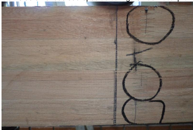
Figura 3.5 – Detalhe de emendas sobrepostas da viga 04 de Eucalipto.
