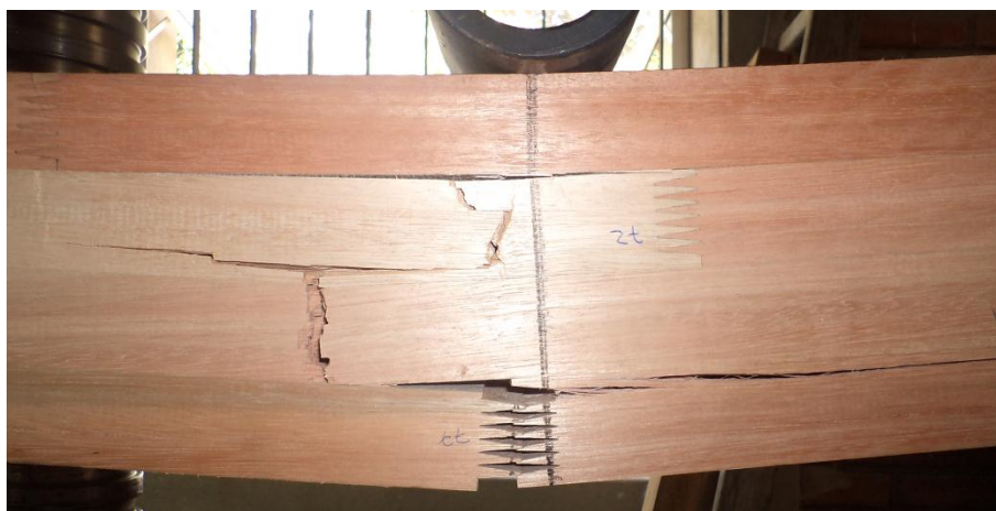
Figura A1 – Forma de ruptura da Viga 01 de Eucalipto.
