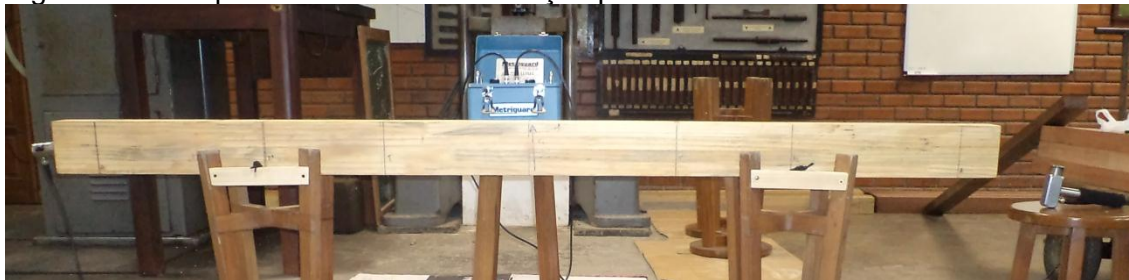
Figura 7.4 – Esquema de ensaio de vibração por “ Stress Wave Timer ”.
