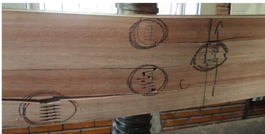
Figura A9 - Forma de ruptura da Viga 09 de Eucalipto
