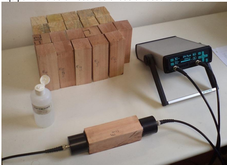
Figura 5.4 – Equipamento de emissão de ondas ultrassonoras – PUNDIT Lab
