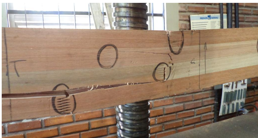
Figura A6 - Forma de ruptura da Viga 06 de Eucalipto
