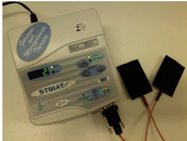
Figura 10 - Para administração da corrente foi utilizado o estimulador modelo: Striat, Ibramed Indústria Brasileira de Equipamentos Médicos Ltd, São Paulo, Brasil. Os eletrodos mediam 35 cm 2 e tinha em sua composição silicone e carbono.
