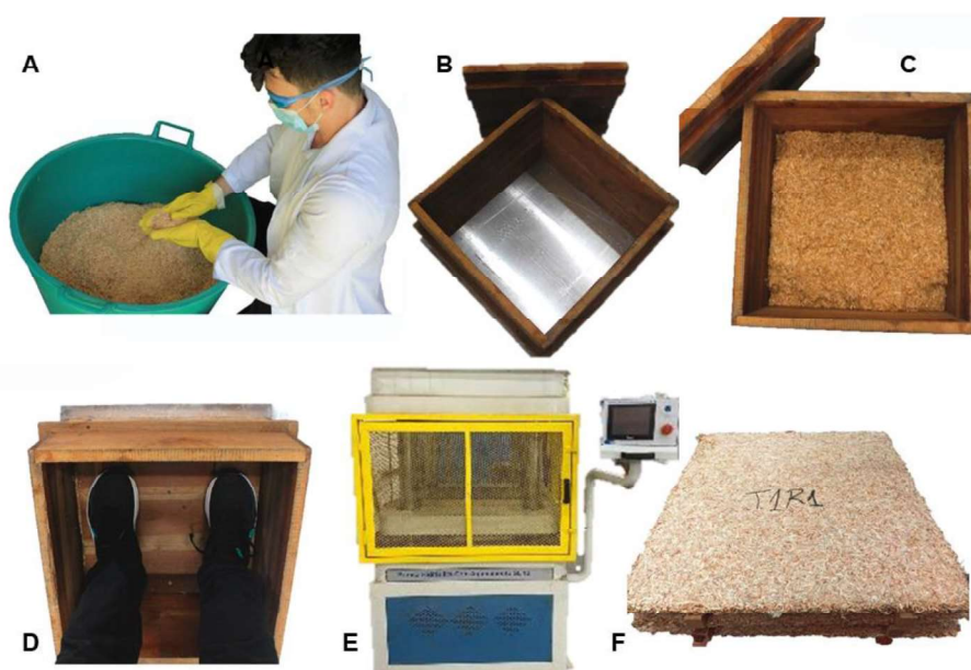
Figura 2. Processo de formação do painel de partículas aglomeradas. A: Homogeneização manual das formulações dos adesivos nas partículas de madeira; B: Fôrma laboratorial com as dimensões de 42,5 cm x 42,5 cm, com tampa introduzível; C: Distribuição das partículas impregnadas de adesivo na fôrma laboratorial; D: Pré-prensagem; E: Prensa hidráulica de pratos aquecidos, e F: Painel aglomerado produzido.
