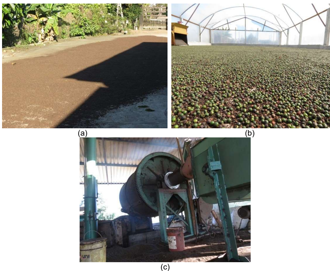
Figura 16. Sistemas de secagem da pimenta-do-reino adotado no norte do Espírito Santo, (a) secagem em terreiro, (b) secagem em estufa e (c) secagem em secador de aquecimento direto.
