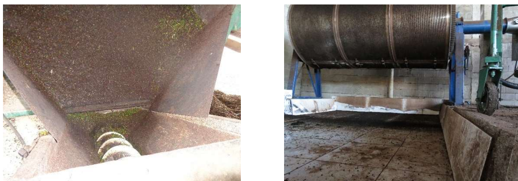
Figura 17. Equipamentos em condições impróprias de higiene, com acúmulo de pimenta-do-reino de processamentos anteriores ou de resíduos de secagem.
