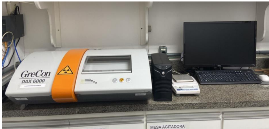
Figura 15: Densitômetro de Raios X
