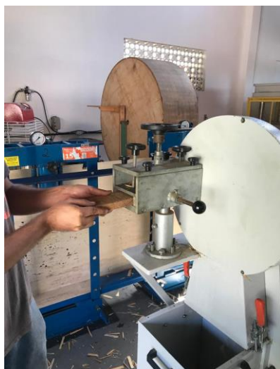
Figura 2: Geração das partículas do tipo flake .
