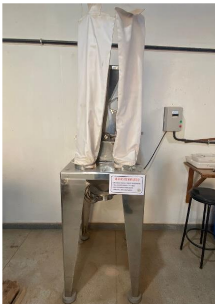
Figura 3: Moinho de martelo com sistema de coleta de poeira.
