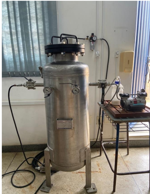
Figura 12: Dispositivo de pressão utilizado para o ensaio de delaminação na linha de cola
