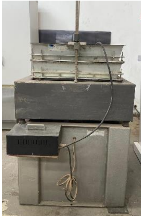
Figura 4: Peneirador de partículas com peneiras acopladas
