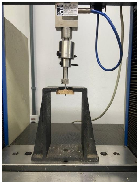
Figura 11: Ensaio de arrancamento de parafuso.
