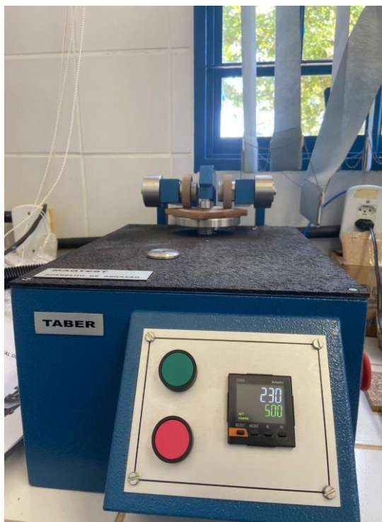
Figura 9: Equipamento abrasímetro utilizado para o ensaio de abrasão.
