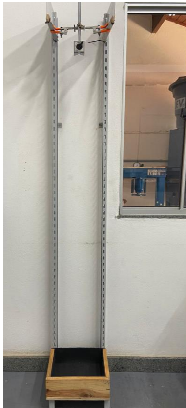
Figura 10: Estrutura montada para o ensaio de impacto
