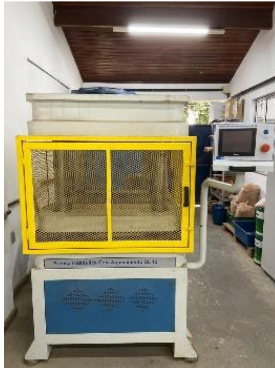
Figura 6: Prensa hidráulica de aquecimento automatizada
