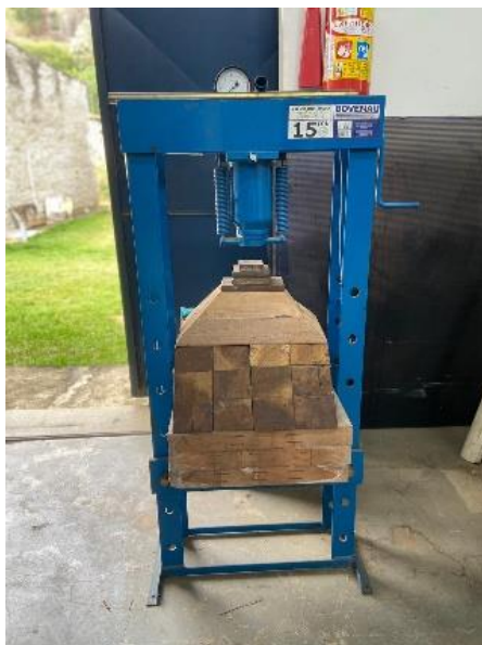
Figura 7: Prensa utilizada para prensagem das taliscas sobre os painéis de partículas, com detalhe da estrutura de dispersão de cargas
