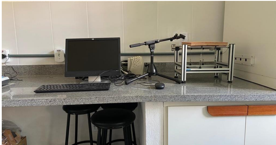
Figura 13: Conjunto Sonelastic montado para realização do ensaio não destrutivo
