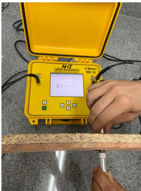
Figura 14: Equipamento utilizado para o ensaio de ultrassom.
