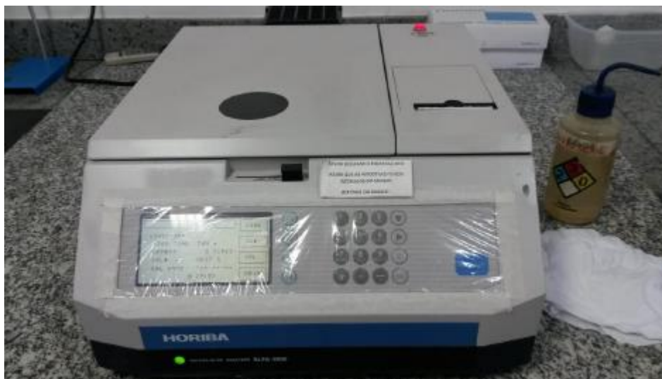
Figura 16. Analisador de enxofre automático fabricante HORIBA modelo SFLA-2800. Fonte: Laboratório de Caracterização e Processamento Primário – Labpetro/UFES.
