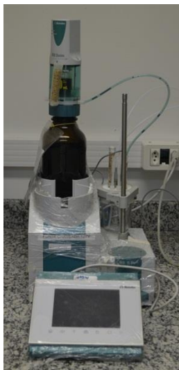
Figura 15. Titulador automático, modelo 905 Titrando, fabricado pela Metrohm. Fonte: Laboratório de Caracterização e Processamento Primário – Labpetro/UFES.
