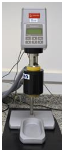
Figura 17. Reômetro rotacional Anton Paar, modelo RheolabQC. Fonte: Laboratório de Caracterização e Processamento Primário – Labpetro/UFES.
