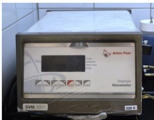
Figura 14. Viscosímetro Stabinger SVM 3000 fabricado pela Anton Paar. Fonte: Laboratório de Caracterização e Processamento Primário – Labpetro/UFES.
