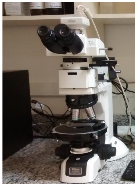
Figura 21. Microscópio Ótico Nikon modelo Eclipse LV100POL. Fonte: Laboratório de Caracterização e Processamento Primário – Labpetro/UFES.
