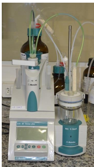
Figura 13. Titulador Karl Fischer Metrohm (modelo 870 KF titrino plus). Fonte: Laboratório de Caracterização e Processamento Primário –Labpetro/UFES.
