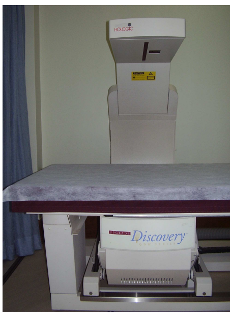
Figura 10. Equipamento utilizado para análise da densidade mineral óssea por absorciometria por dupla emissão de raio X (DXA), pertencente ao CEDOES.
