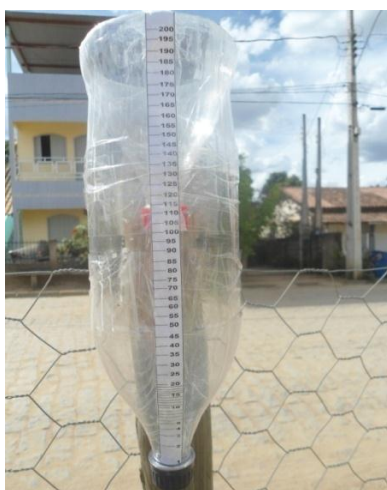
Figura 50: Pluviômetro pronto para receber água da chuva
