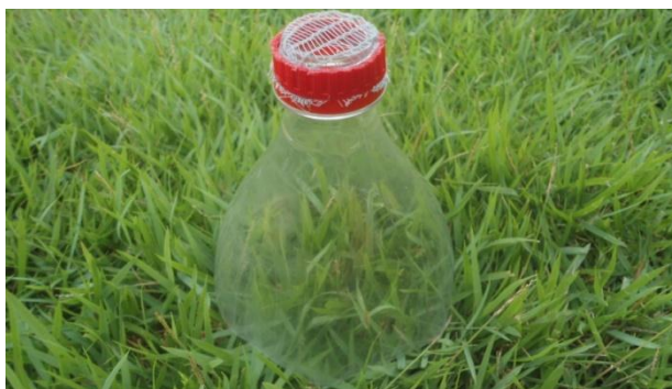
Figura 48: Pet cortado a 11,5 cm do bico
