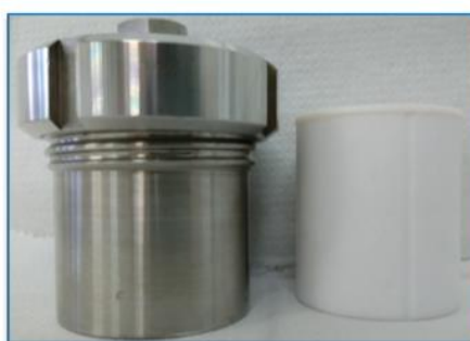
Figura 22: Representação esquemática da reação (a) e reator solvothermal utilizado na síntese do MOF-76 (b).
