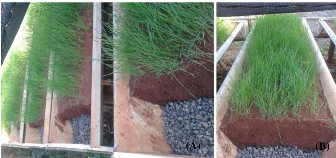
**Figura 3** – Rampas de tratamento (3A) e sistema de registros e tubulações perfuradas utilizados para aplicação do esgoto doméstico nas rampas de tratamento (3B).
