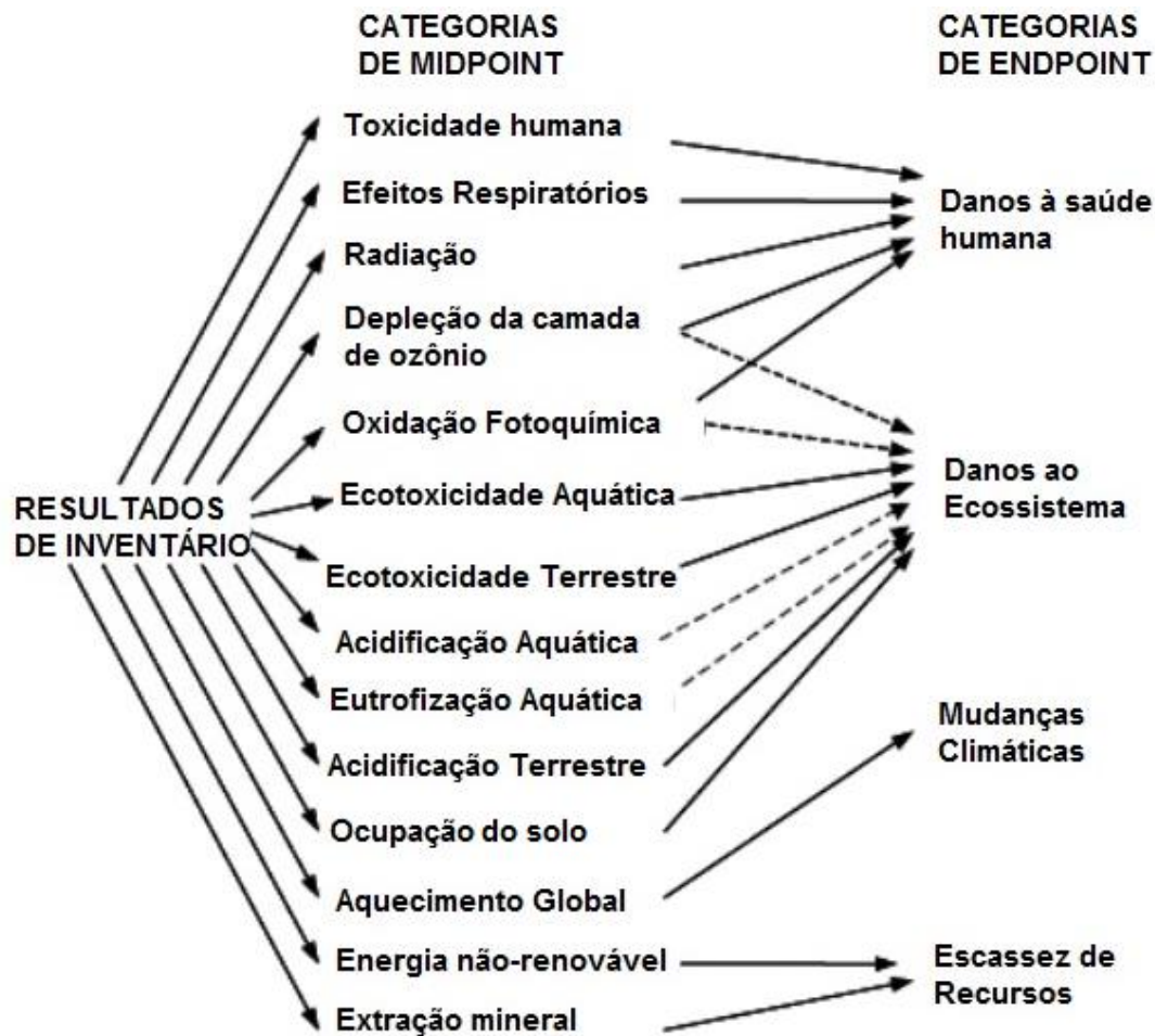
Figura 5 – Esquema Geral do método IMPACT 2002+ ligando as categorias de Impacto ( midpoints ) a suas respectivas categorias de Danos ( endpoints ), com base em Joillet et al. (2003)
