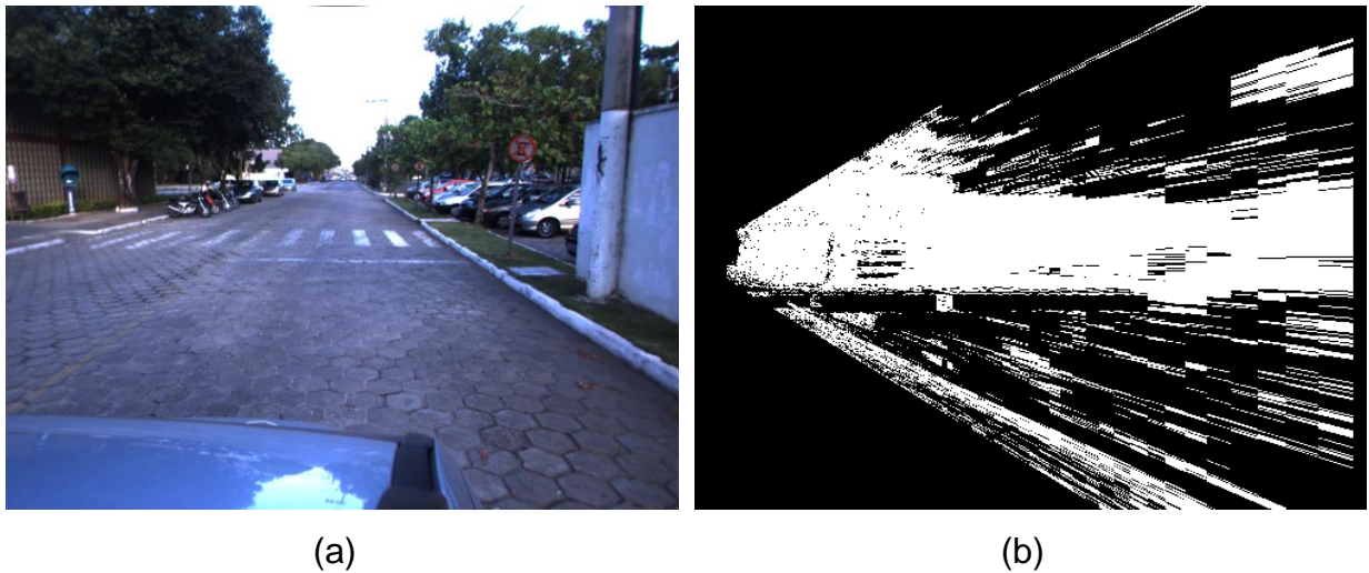
Figura 39 – Limitações do classificador para identificação de faixas e sinalizações desenhadas sobre a região trafegável. (a) Imagem de referência (capturada pela câmera direita). (b) Resultado da classificação realizada sobre a imagem de referência após realizar o mapeamento inverso de perspectiva.
