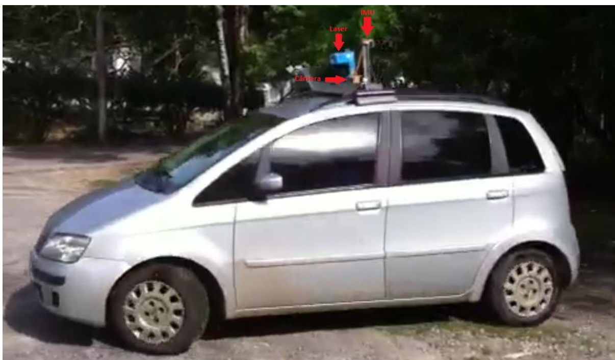
Figura 24 – Vista lateral do veículo experimental. Localizado acima do veículo, uma câmera estéreo, um sensor de medida inercial (IMU) e um Laser Range Finder (não utilizado pelo sistema de mapeamento).
