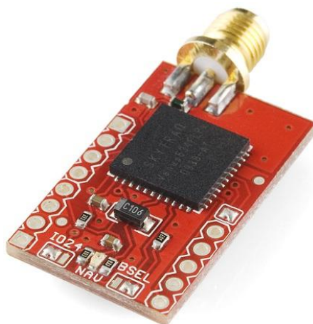
Figura 27 – Sistema de Posicionamento Global Venus GPS 09133.
