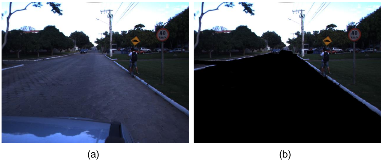
Figura 21 – Imagem estática 2. (a) Imagem de referência (capturada pela câmera direta do par estéreo). (b) Imagem editada manualmente, identificando em preto a região trafegável.
