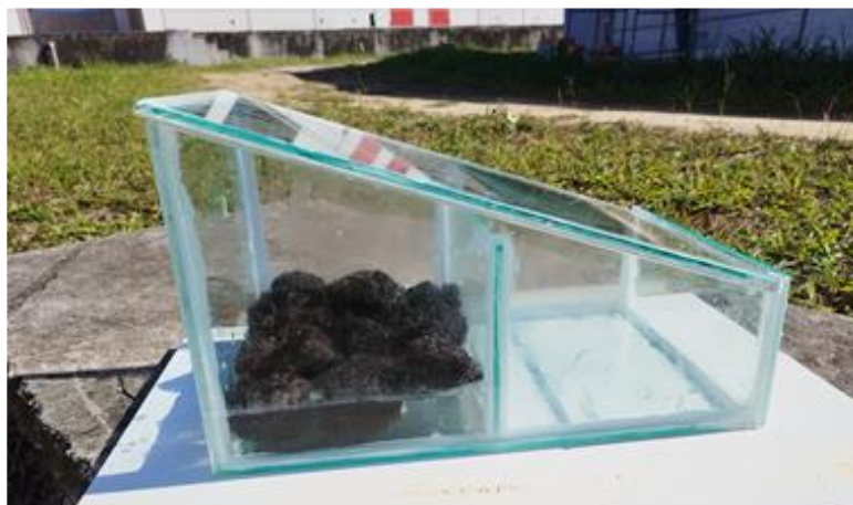
Figura 25 — Fotografias do destilador solar construído: a) destilação com MAF e b) destilação simples.
