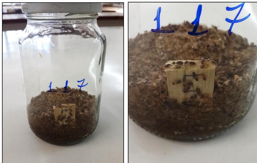
Figura 11 – Frasco preparado para o ensaio de alimentação forçada com térmitas subterrâneos.
