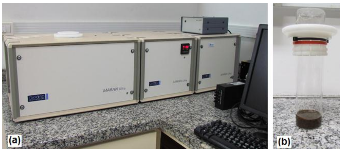
Figura 27. Equipamento de RMN-DT presente no NCQP/LABPETRO-UFES (a) e porta-amostras (b). 64
