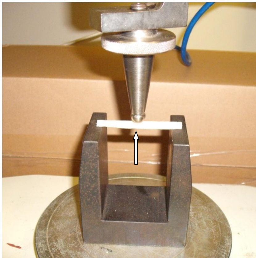
Figura 6 - Corpo de prova (seta) posicionado para ser submetido ao ensaio de flexão em três pontos.
