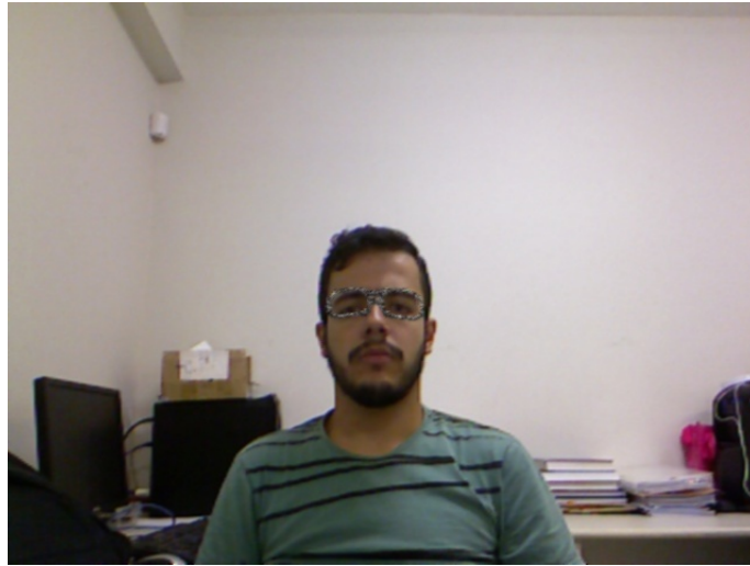
Figura 4.9: Imagem capturada pela câmera RGB-D com dimensão de 640 \times 480 e com o objeto virtual renderizado.
