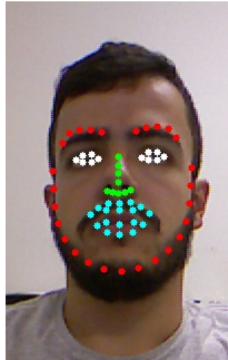
Figura 3.1: Pontos de interesse faciais 2D detectados pelo método FaceTracker. Ao todo, detectamos 66 pontos de interesse divididos em 4 grupos: os pontos vermelhos são os pontos de contorno da face, os pontos brancos são os pontos de interesse do olho, os pontos verdes são pontos de interesse do nariz e os pontos azuis são os pontos de interesse internos e externos dos lábios.
