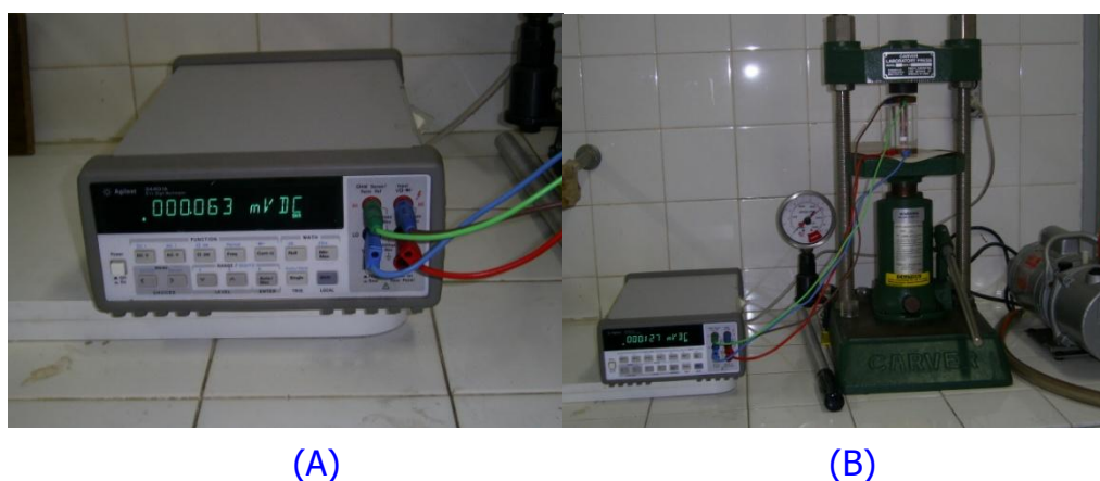
FIGURA 3.8 – Material utilizado para medidas de resistividade elétrica DC das amostras sintetizadas. (A) Multímetro e fonte DC modelo 33401 A da Agilent; (B) Multímetro ligado ao cilindro dentro da prensa.
