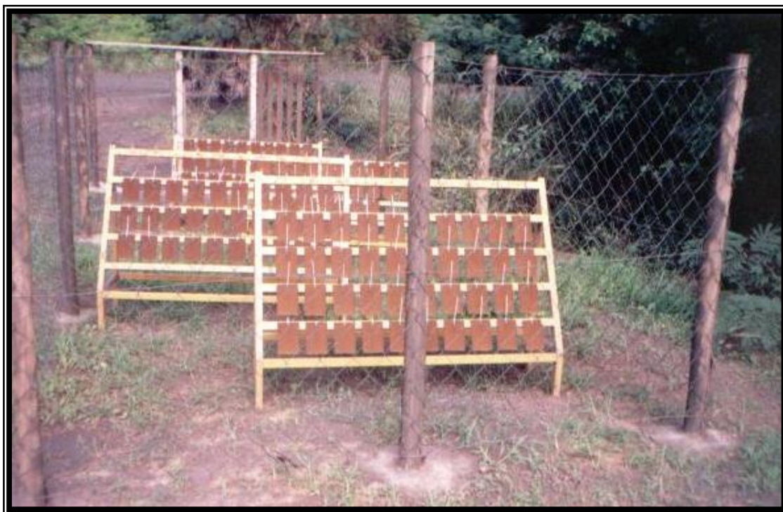
Figura 2.3 – Corpos-de-prova expostos no Pátio B.
