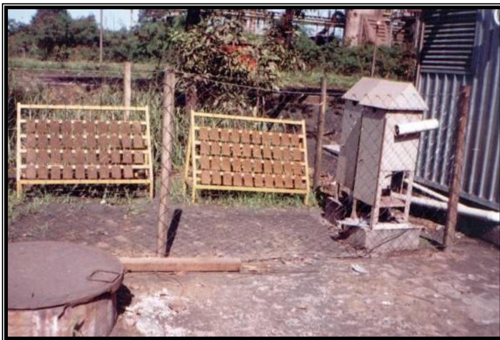
Figura 2.4 – Estação de exposição atmosférica na Usina 1.
