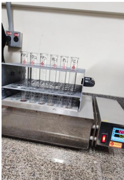
Figura 16 - Bloco digestor de proteínas
