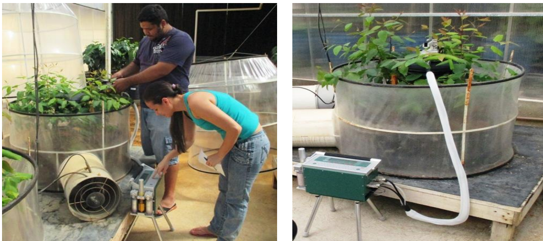
Figura 10 – Coleta de dados com o analisador de gases por infravermelho (Li-Cor, modelo Li 6400).
