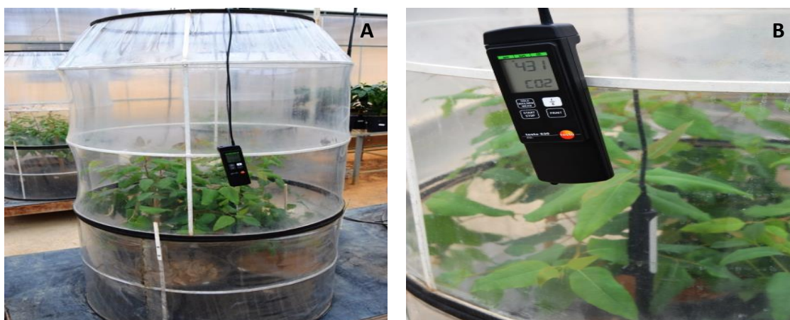
Figura 7 – Monitoramento da concentração de CO 2 com o analisador portátil. (B) Detalhe do analisador portátil em uso (B).
