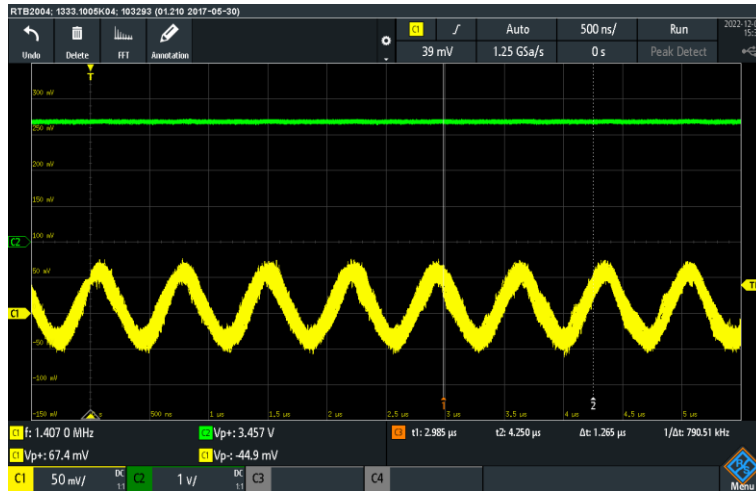
Figura 42 - Sensor imerso em água ( V_{ADC} = 3,457 \text{ V} )
