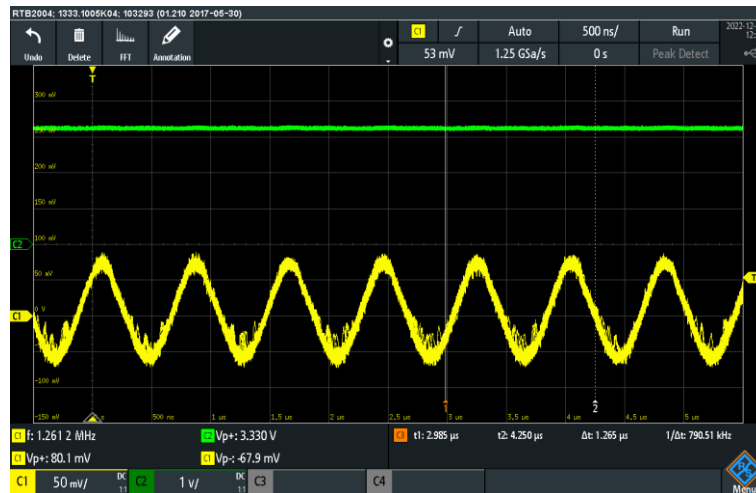
Figura 52 - Tensão no resistor Shunt (sensor imerso em água ultra pura) (freq. 1,26 MHz, 60/60 espiras)
