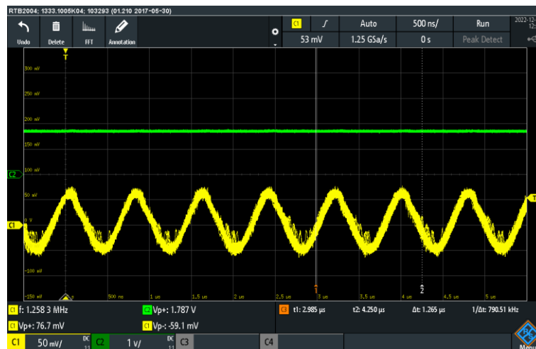
Figura 53 - Tensão no resistor Shunt (sensor imerso em água corrente) (freq. 1,26 MHz, 60/60 espiras)
