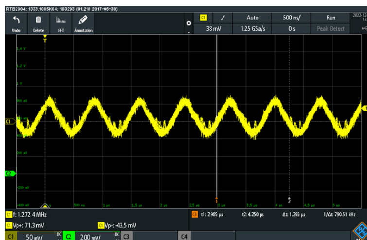
Figura 50 - Corrente elétrica no resistor Shunt (sensor imerso na água) (freq. 1,27 MHz, 60/60 espiras)
