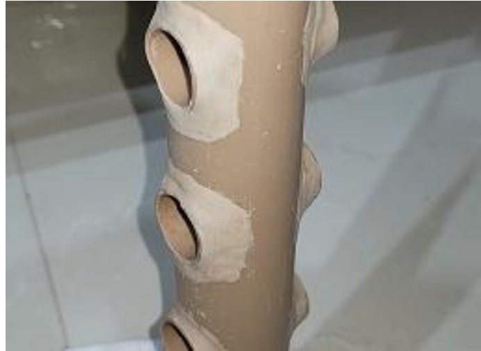
Figura 24 - Sensor protegido com massa epóxi
