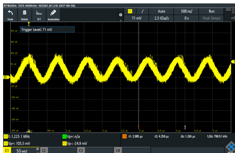
Figura 46 - Tensão no resistor Shunt (sensor fora da água) (freq. 1,23 MHz, 60/60 espiras)
