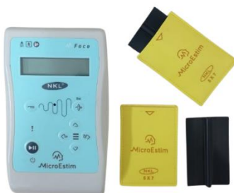
Figura 7 - MicroEstim Foco Research NKL, equipamento utilizado para a neuromodulação com ETCC, acompanhado de eletrodos envoltos por esponja.
