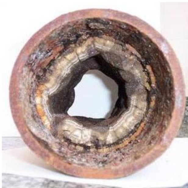
Figura 1. Depósito de sais insolúveis (incrustações) em coluna de produção. (fotografia cedida pelo CENPES/Petrobras)
