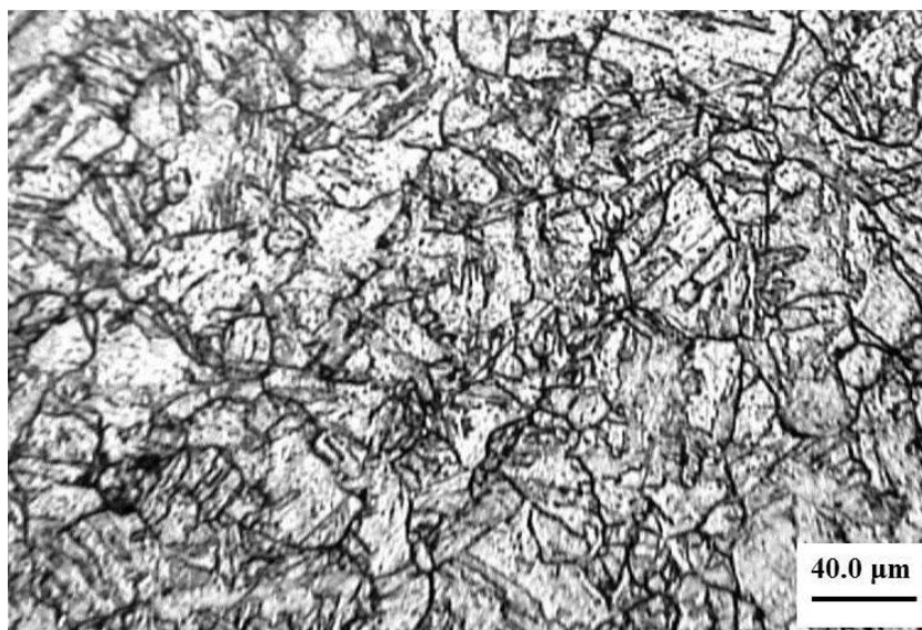
Figura 25 - Micrografia da amostra TD-500. Contornos de grãos bem revelados de austenita prévia (Ataque eletrolítico em solução 0,25 M \text{H}_2\text{SO}_4 + 0,1 M KSCN).
