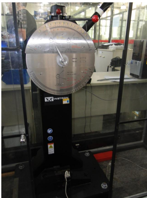
Figura 16 - Aparelho que foi utilizado para a realização do ensaio Charpy Instrumentado.
