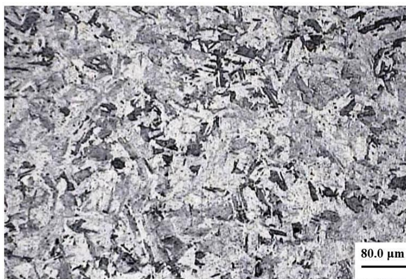
Figura 23 - Micrografia da amostra TS-650, presença de nitreto de titânio (estão representados pela coloração preta) (ataque: Oxálico).
