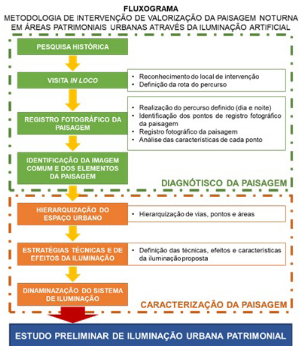
Figura 5 – Fluxograma da metodologia construída através da experimentação
