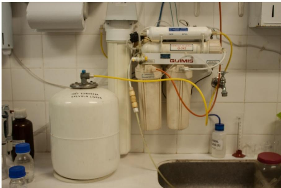
**Figura 7.** Sistema de deionização Quimis Q180 seguido de um sistema de osmose reversa Quimis Q342.
