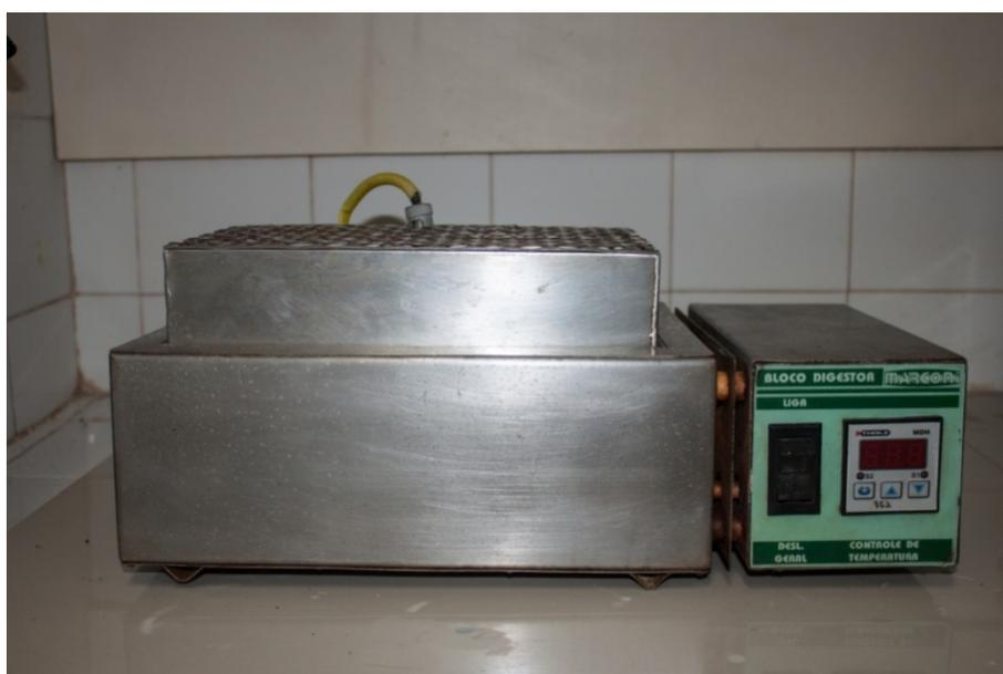
**Figura 4.** Bloco digestor Marconi MA4005/ME com acessório para banho-maria.
