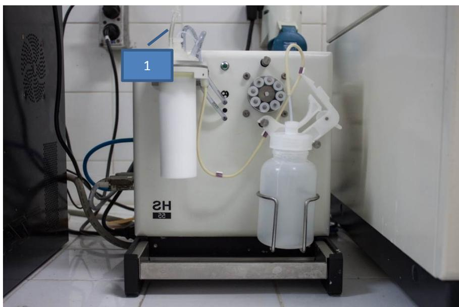
**Figura 5.** Gerador de vapor frio Analytik Jena HS55. 1 - tubulação de saída de gases do reator do gerador.
