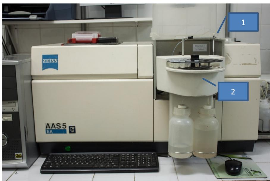
**Figura 6.** Espectrômetro de absorção atômica com forno de grafite Zeiss AAS5 EA. 1 – ponteira do auto-amostrador. 2- auto-amostrador.
