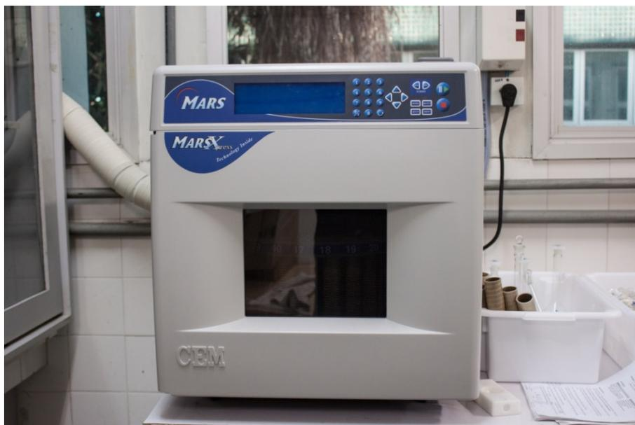
**Figura 3.** Micro-ondas modelo MD-4531, da CEM Corporation.
