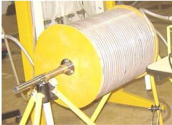
Figura 17.4. Floculador Tubular Helicoidal.
