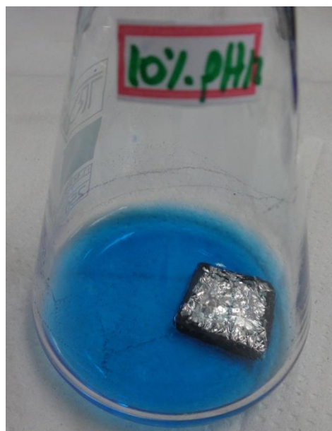
Figura 11. Imagens do ensaio de adsorção do azul de metileno. a) alíquota da solução concentrada de 80 ppm mais a amostra contendo 10 % de Ni em pH 12 e b) solução de azul de metileno após 30 min de tratamento, onde as partículas (pH 12 e 10 % de Ni) estão sendo removidas pelo ímã.
