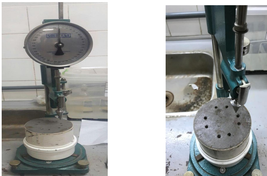
Figura 15 – Aparelho do Cone Fall Test com as posições de penetração
