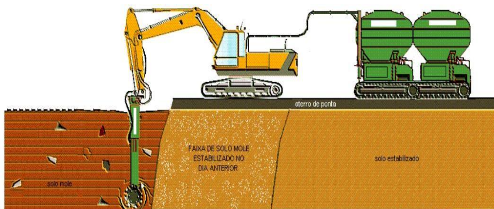
Figura 9: Detalhe esquemático do equipamento e do processo Stabtec®
