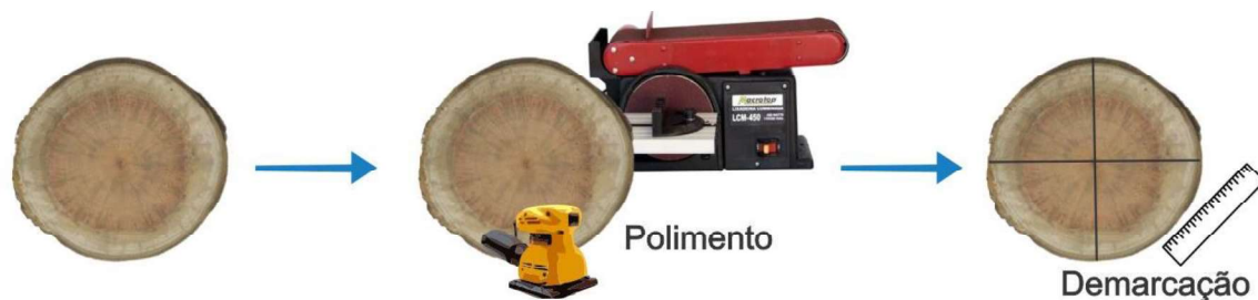
Figura 3. Sequência do processo de mensuração das propriedades macroscópicas da casca e do lenho.
