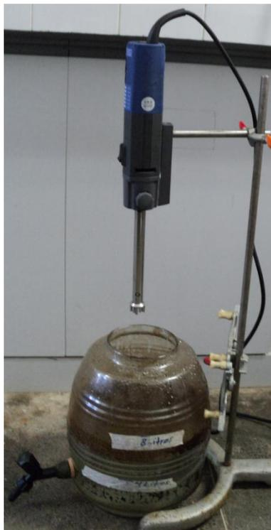
**Figura 11.** Preparo da água de produção sintética utilizando o T18 basic ULTRA-TURRAX®
